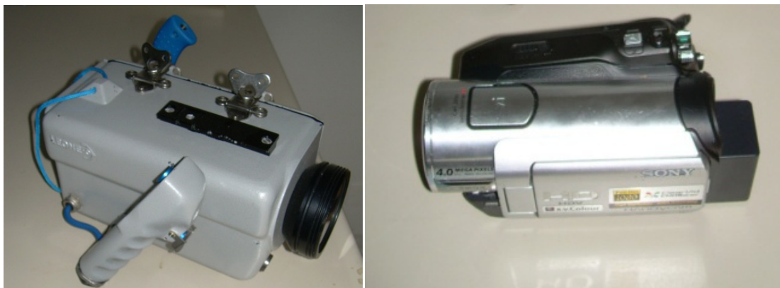
Figura 12 – Custodia subacquea (Leone Oyster LR a sinistra) e telecamera Sony HC-5 utilizzate per le riprese dei transetti.
