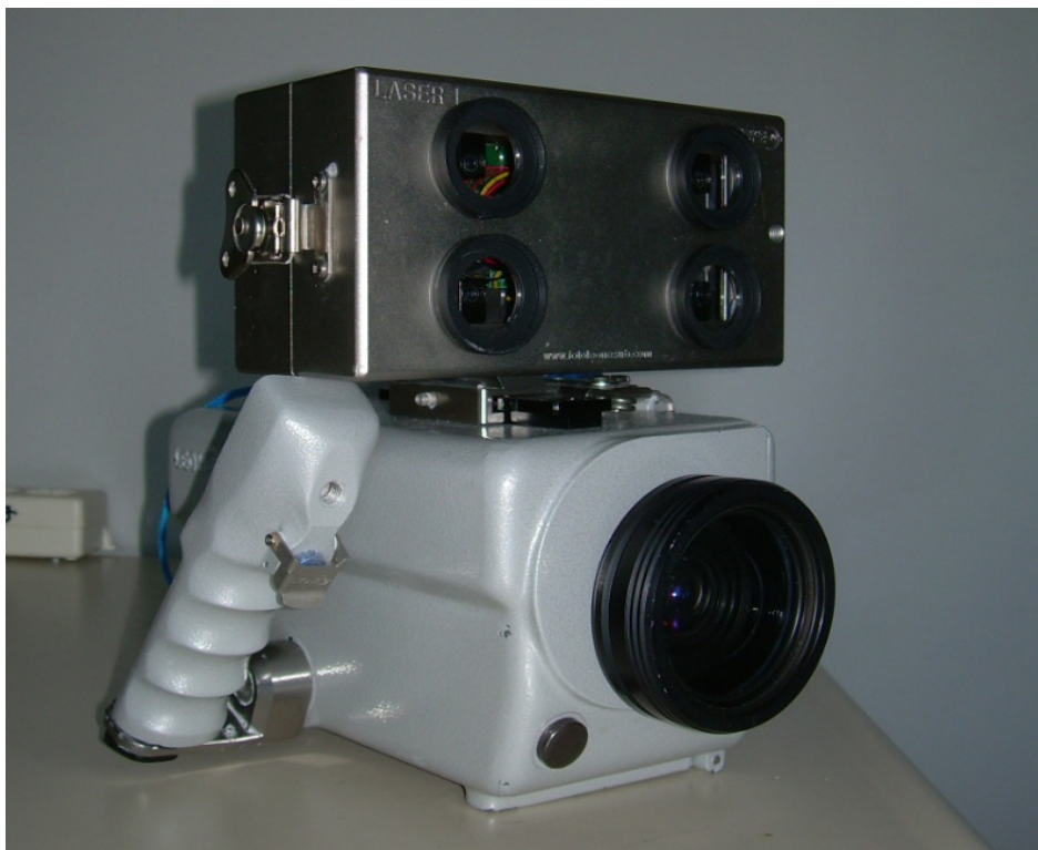
Figura 64 – Il sistema “LASER 1” (Ditta Leone) montato sulla staffa dei flash della custodia (Oyster L, Ditta Leone).
