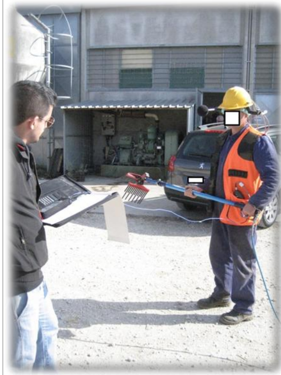
Fig. 5.1 Casi di applicazione pratica del brevetto Kit indossabile per la misurazione del rumore e delle vibrazioni.
