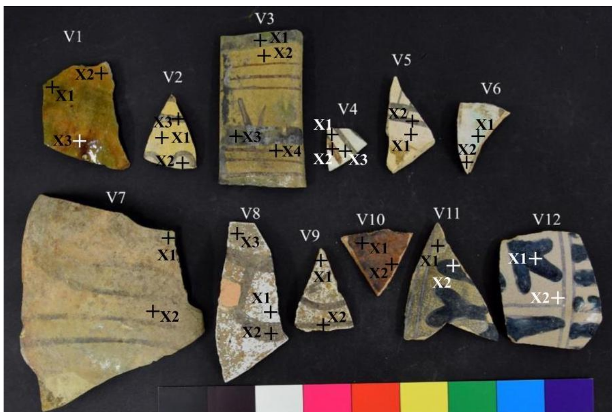
Fig. 9: Fronte dei campioni ceramici di Via Zelli Pazzaglia con la segnalazione dei punti in cui è stata effettuata l’analisi XRF.
