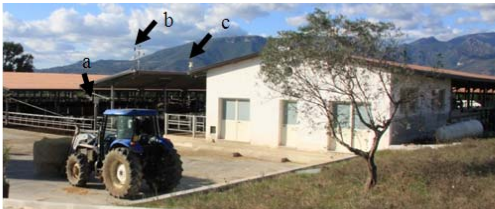
Figura 2-22: Veduta d'insieme dell'azienda e della strumentazione installata, a) posizione del datalogger, b) posizione dell'anemometro, piranometro e termoigrometro, c) posizione del pluviometro
