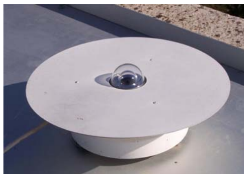
Figura 2-19: Particolare del piranometro
