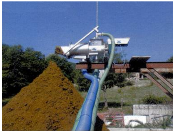
Figura 2-3: Separatore a vite elicoidale ( www.ersaf.lombardia.it )
