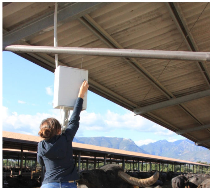
Figura 2-25: Attività di prelievo dati dal datalogger CR10X
