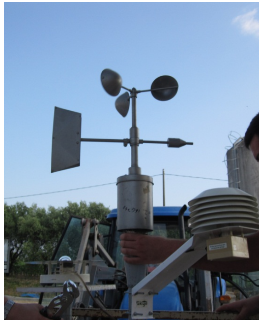
Figura 2-18: Particolare dell'anemometro e del termoigrometro
