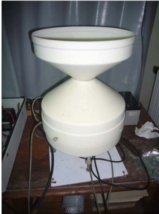
Figura 2-21: Particolare del pluviometro
