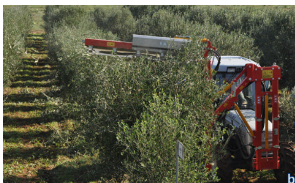
Figura 9. Meccanizzazione della potatura in sistemi d'impianto a "Parete verticale" (a). Interventi meccanici di topping (b), seguiti da leggeri interventi manuali di correzione, possono essere effettuati con cadenza annuale o biennale in rapporto al vigore della cultivar e all'ambiente.
