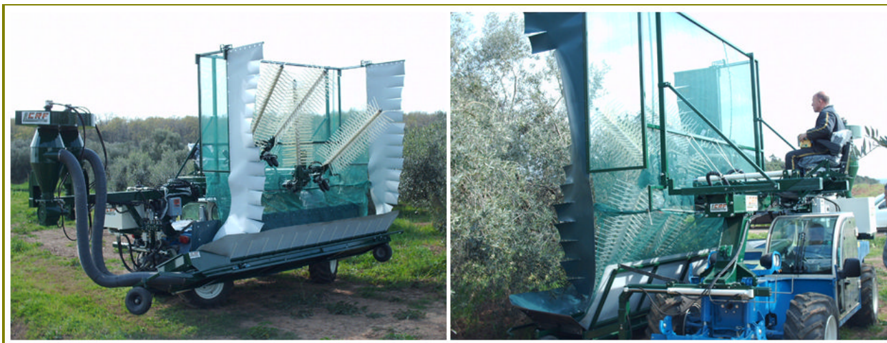
Figura 8 Meccanizzazione della raccolta per bacchiatura della chioma di piante di olivo: la macchina, semovente, opera in continuo lungo il filare e avanza lateralmente rispetto alla chioma delle piante che possono anche raggiungere i 4 metri di altezza (CRF - Olive two semovente).
