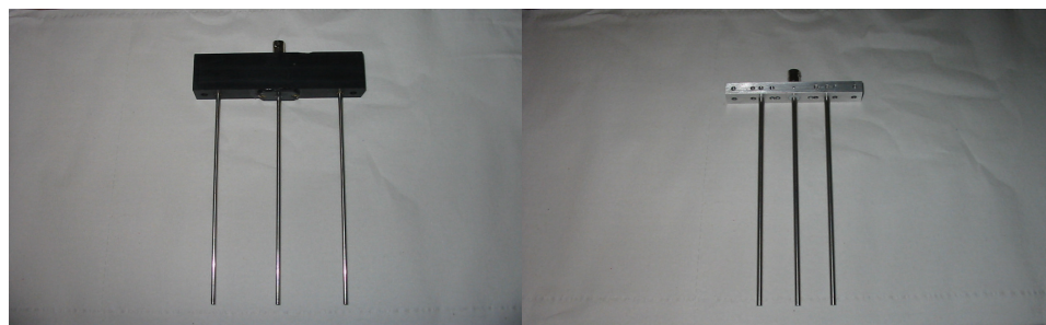
Figura 4.3 Prototipo della sonda trifilare con supporto in PVC (sinistra) e metallico (destra).
