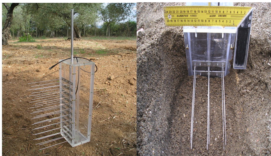
Figura 7.9 Sonda multilivello prima e durante il riempimento della vasca.
