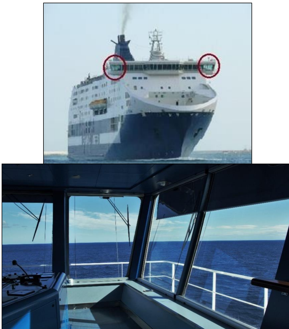
Figura 18 Posizionamento dell'osservatore sull'aletta del ponte di comando e interno dell'aletta del ponte di comando
