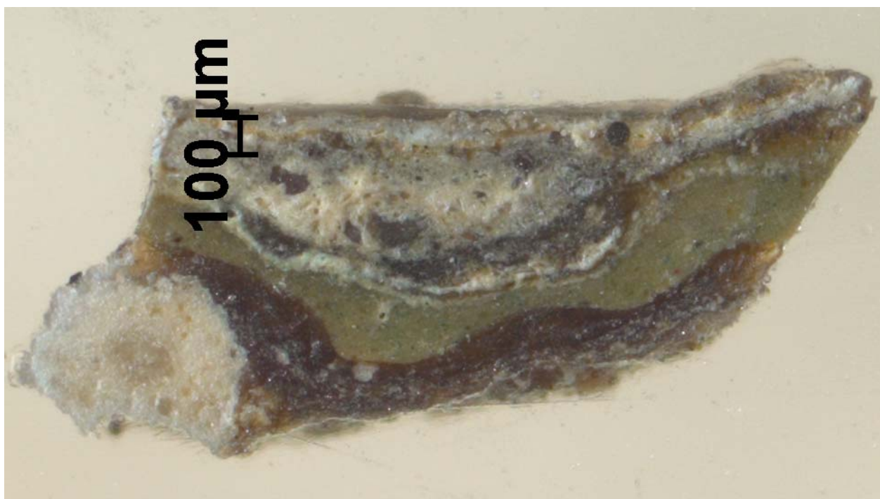
Figura 16 – Sezione lucida del campione OC1 a luce riflessa, ingrandimento obiettivo 2,5x.
