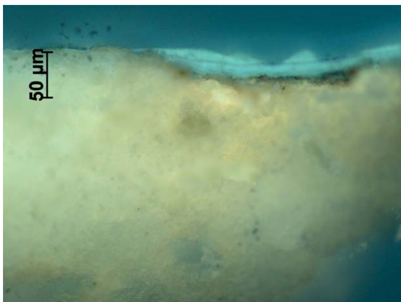
Figura 11 – Sezioni lucide del campione MB2 a luce riflessa e in fluorescenza UV, ingrandimento obiettivo 20x.
