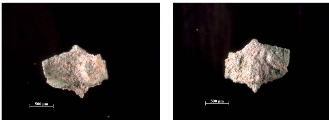
Figura 29 – Foto al microscopio stereo del microframmento TM1 prelevato dalla terracotta con tracce di patinatura. Fronte e retro del frammento, ingrandimento obiettivo 2,5x.
