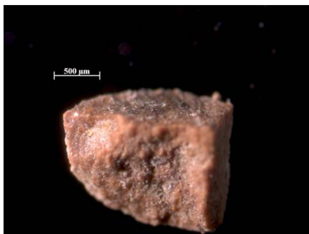
Figura 26 – Foto al microscopio stereo del microframmento SGB1 prelevato dalla terracotta con tracce di patinatura dipinta. Ingrandimento obiettivo 2,5x.
