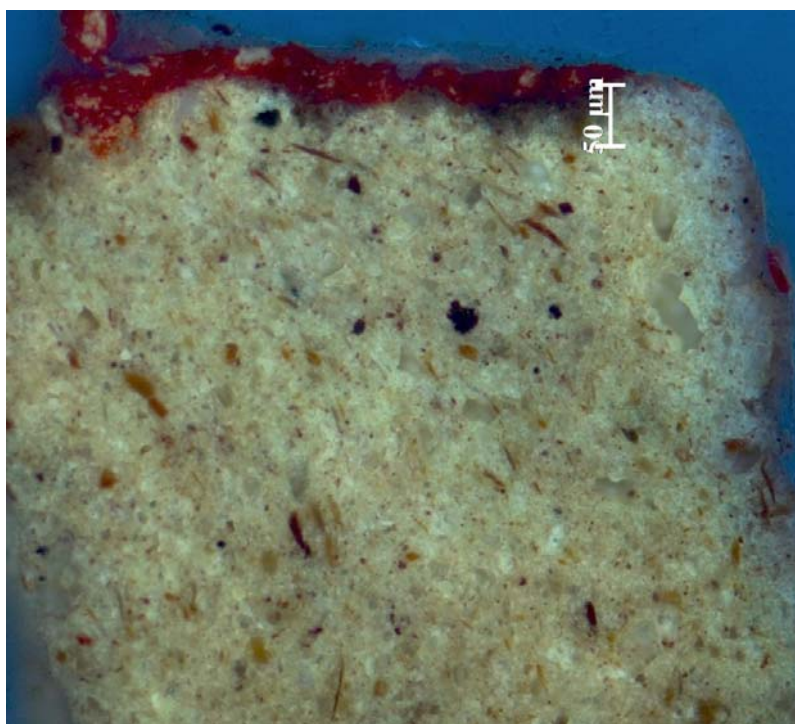
Figura 32 – Sezioni lucide del campione AP1 a luce riflessa e in fluorescenza UV, ingrandimento obiettivo 10x.
