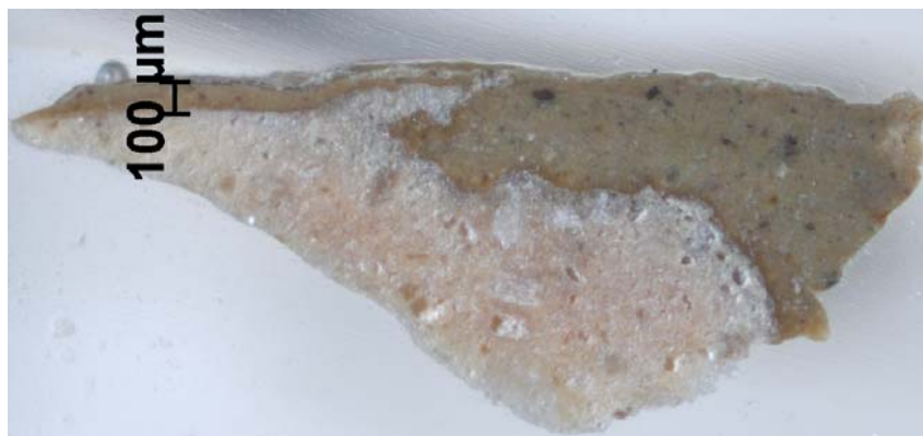
Figura 24 – Sezione lucida del campione OC1 a luce riflessa, ingrandimento obiettivo 2,5x.
