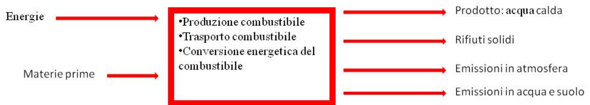
Fig. 6: Diagramma IDEF0 per filiere energetiche.
