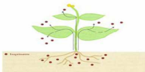
Figura 4. Rappresentazione schematica del meccanismo di fitovolatilizzazione
