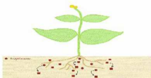
Figura 3. Rappresentazione schematica del meccanismo di fitostabilizzazione
