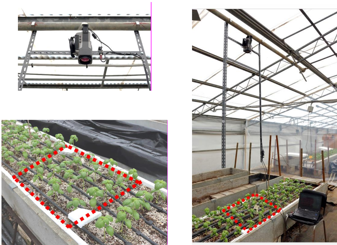
Figura 3.6 Posizionamento della termocamera sopra il bancale e dimensione area acquisizione.
