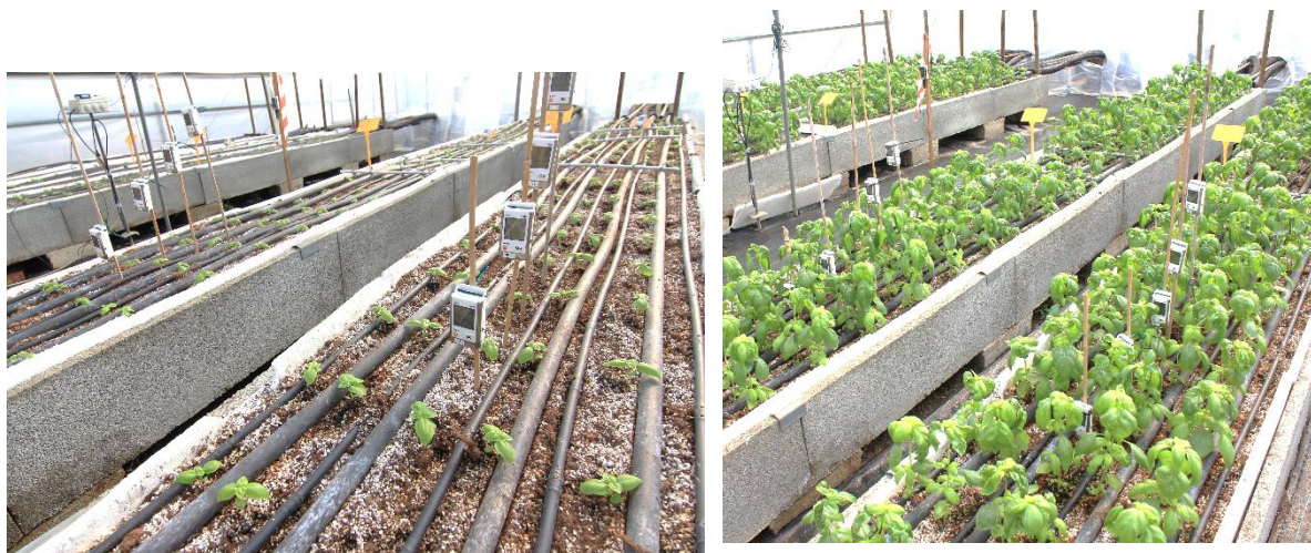
Figura 4.7 Datalogger all'interno delle linee sperimentali riscaldate con impianto basale.
