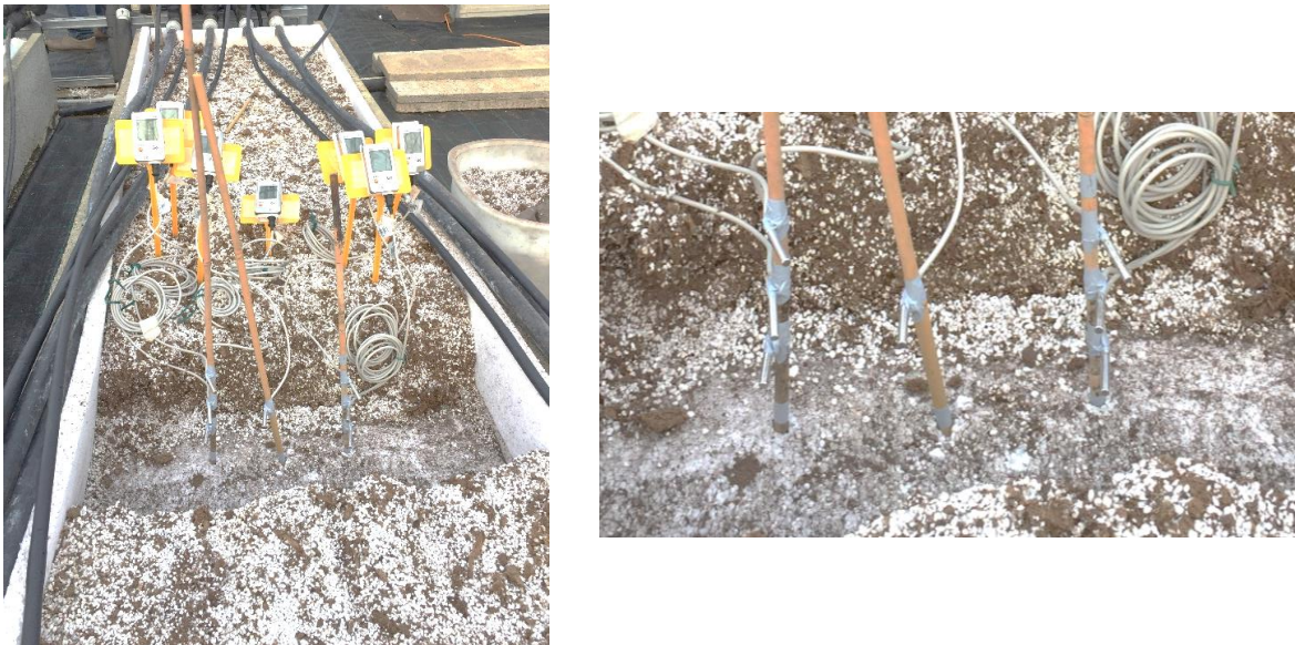
Figura 5.3 Realizzazione della griglia di sonde all'interno del bancale.
