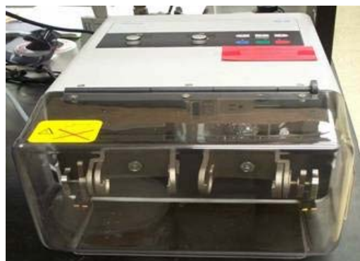
Figura 23. Mixer Mill 300 (QIAGEN) per la macinazione di tessuto fogliare congelato in azoto liquido.
