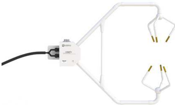
Figura 17: Anemometro sonico tridimensionale CSAT3 della Campbell Scientific
