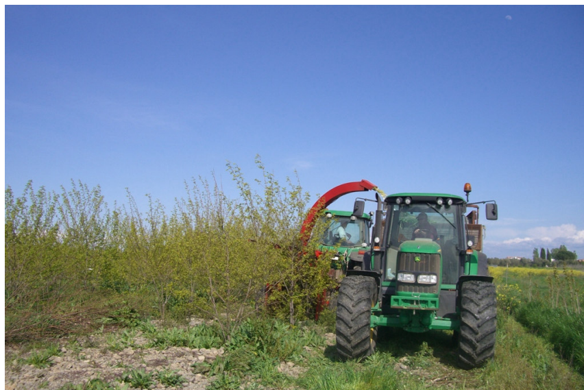
Foto:34.Taglio e sminuzzatura delle piante di robinia con la trincia caricatrice
