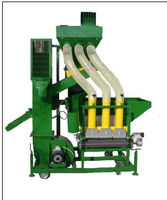
Figura 1- pulitore mod. S98-200 capacità 3 t/h (gentile concessione ditta CHIANCHIA)
