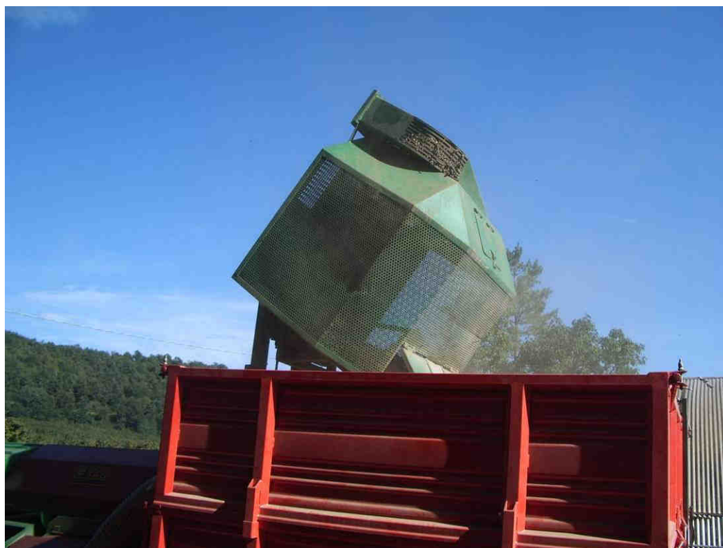
Foto 15 - svuotamento cassone da Facma Cimina 300s (Az. La Ferrera, Settembre 2006)
