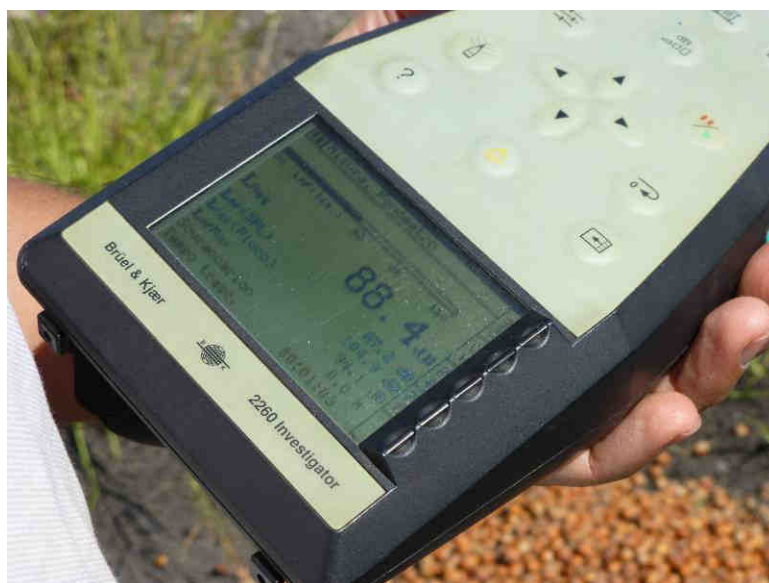
Foto 33- Fonometro Brüel&Kjær Investigato 2260 (Cherasco 27/08/2012)
