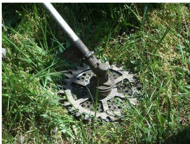
Foto 13 - Disco spollonatore RIVMEC montato su decespugliatore (Cravanzana 27 aprile 2011)
