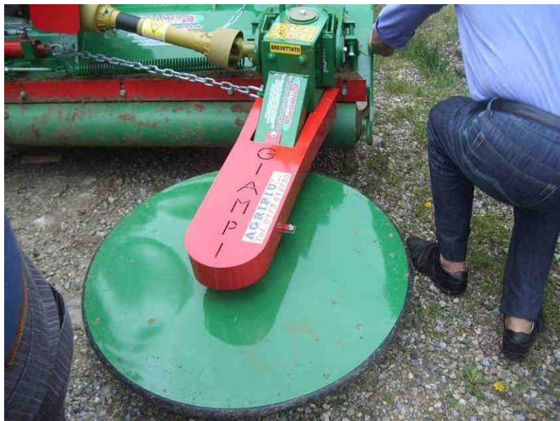
Foto 9 - Trincia GIAMPI montata su trattore (Cravanzana 27 aprile 2011)
