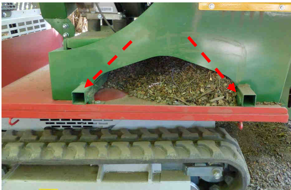
Foto 47 - applicazione scatolati per inserimento cavalletti (Cherasco 27/08/2012)
