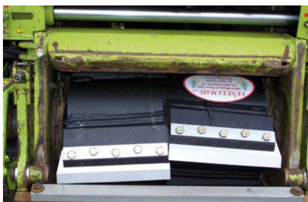
Figura 30: il rotore di seconda generazione allestito nella camera di trinciatura della CLAAS JAGUAR.
