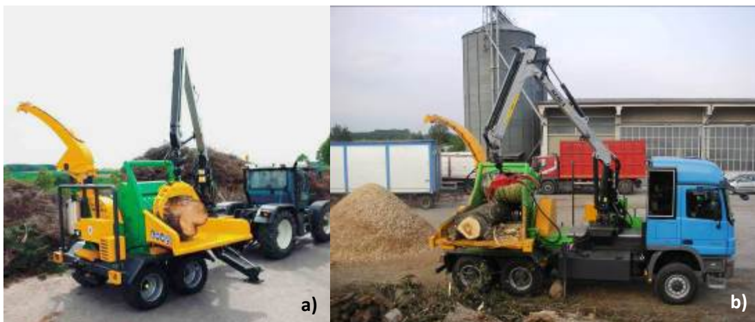
Figura 14: sminuzzatrici trainate a); sminuzzatrici semoventi b)
