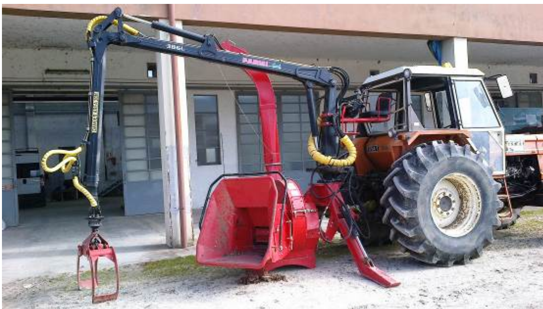
Figura 13: sminuzzatrice alimentata da pinza idraulica, azionata dalla presa di potenza del trattore
