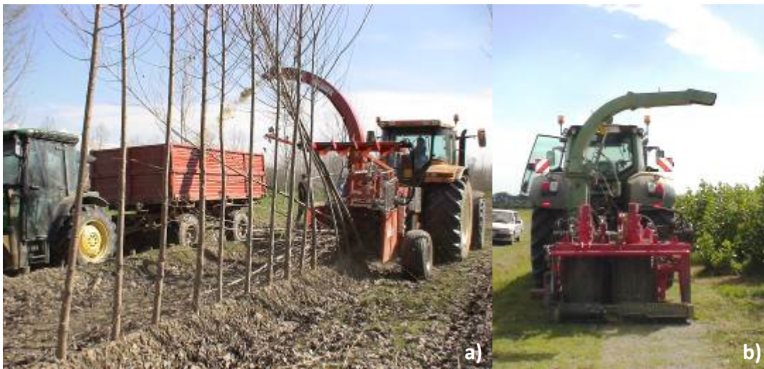
Figura 17: falciatrinciacaricatrice Spapperi mod. RT a); trinciacaricatrice Jordan RH 25 b);
