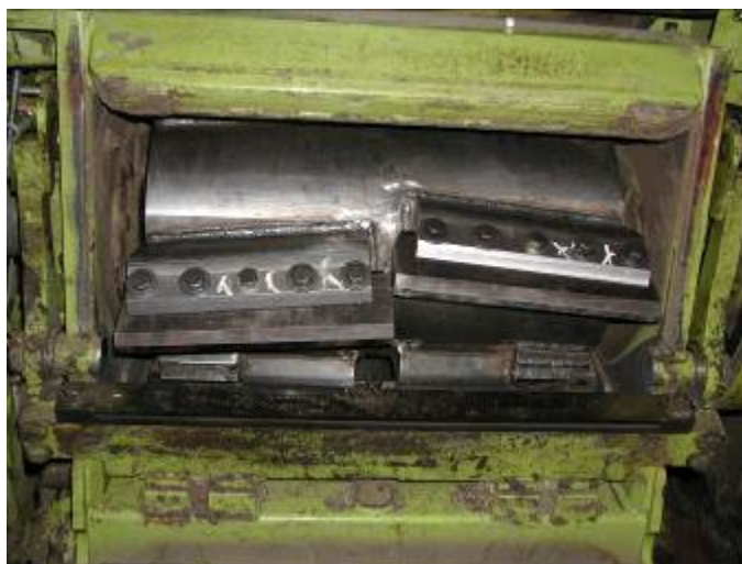
Figura 26: rotore di I generazione nella camera di trinciantura della CLAAS JAGUAR
