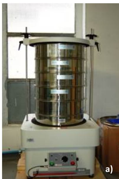
Figura 32: setacciatore meccanico (a); pila di setacci di dimensioni adeguate in ordine decrescente, 1) diametro dei fori in aumento, 2) Materiale aggiunto, 3) direzione del flusso del materiale (b).
