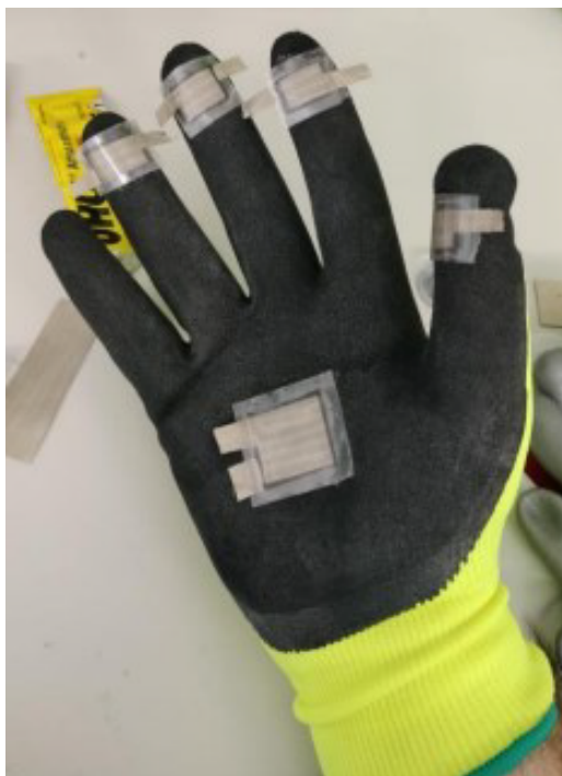
Figura 5.18: Palmo del guanto sensorizzato con sensori piezoresistivi
