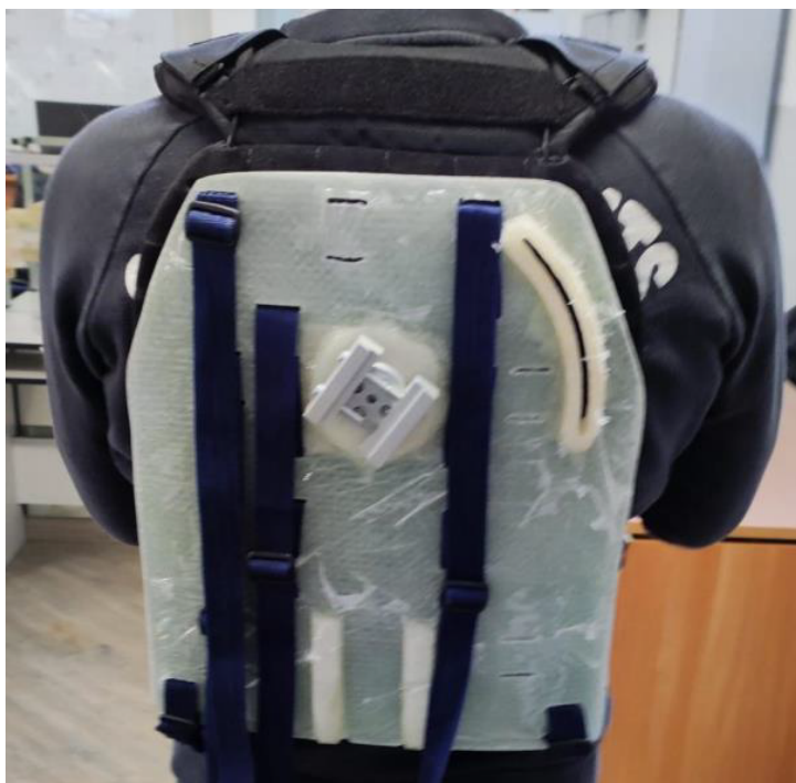
Figura 3.24: Piastra esterna realizzata in fibra di vetro
