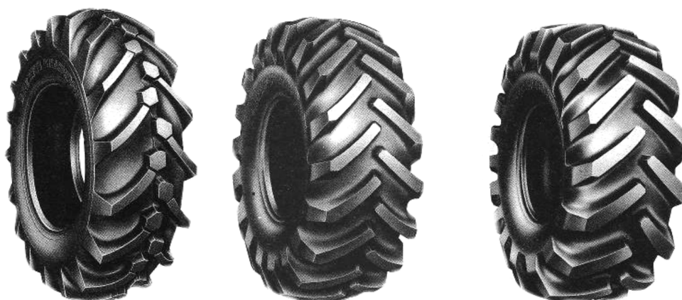
Fig. n° 11 - Pneumatici forestali composti da 12 tele
