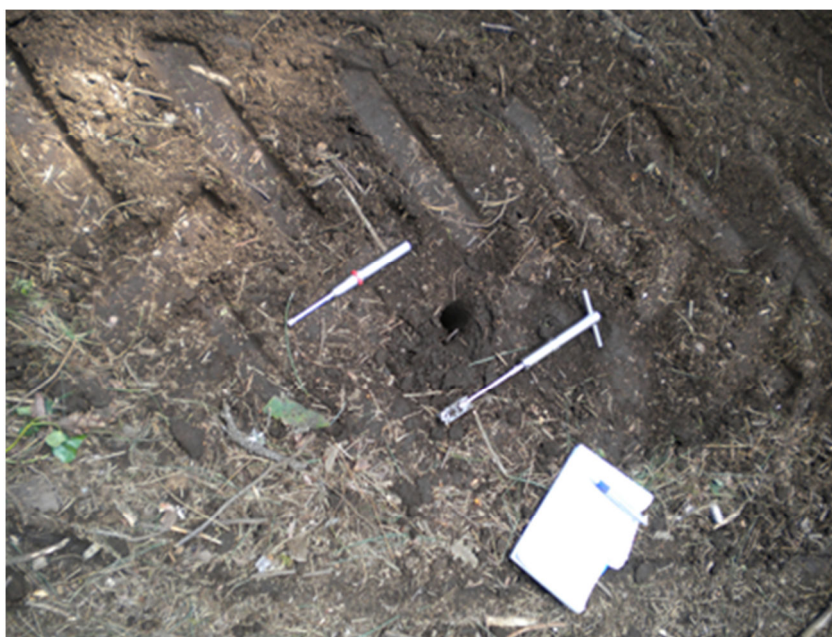
Foto n°2 - Penetrometro, Scissometro e Taccuino di campagna accanto al foro fatto dal Carotatore sull'impronta del pneumatico
