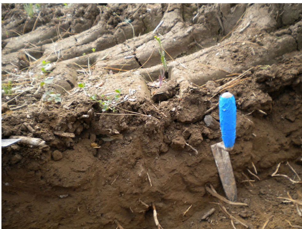
Foto n°22a e 22b – Particolare della trincea, come si può osservare la parte compattata presenta il terreno a grumi rispetto a quello non disturbato
