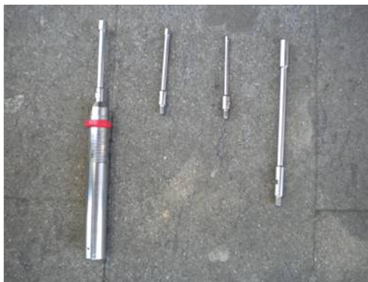
Foto n°5 - Penetrometro con le 3 aste di campionamento e prolunga per indagine profonda
