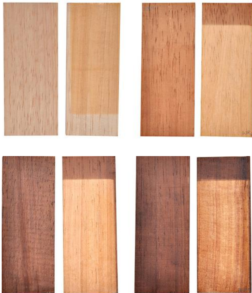
Figura 3.18 effetti del trattamento termico sul colore del legno trattato e non trattato. Il colore del legno diventa significativamente scuro all'aumentare dell'intensità del trattamento (fonte Srinivas et al., 2012)
