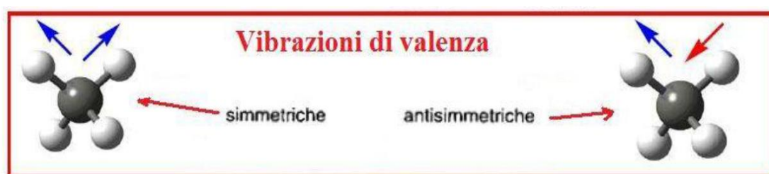
Figura 4.34 esempio di modi di vibrazione di valenza e vibrazioni "bending" o di deformazione (variazione dell'angolo di legame).
