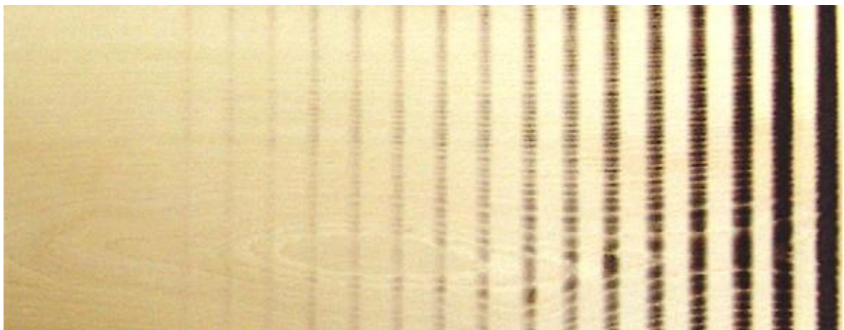
Figura 3.17 Superficie del legno di faggio ( Fagus sylvatica L.) a seguito di irradiazione laser. Ogni banda corrisponde ad una particolare dose di irradiazione (il valore varia da 14 a 57 J/cm 2 ), (fonte Kubovsky et al., 2011)
