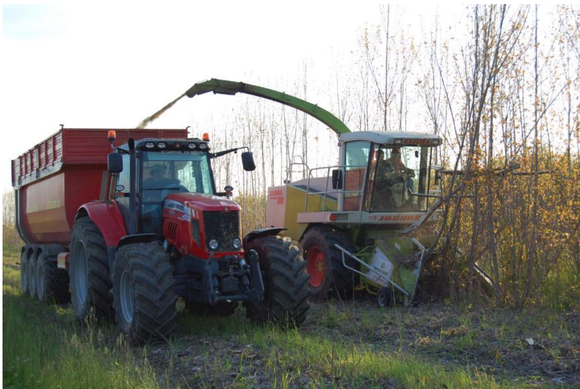
Figura 47: Fase di raccolta del pioppo con falcia trincia caricatrice CLASS Jaguar 800 e testata RU450 Xtra.
