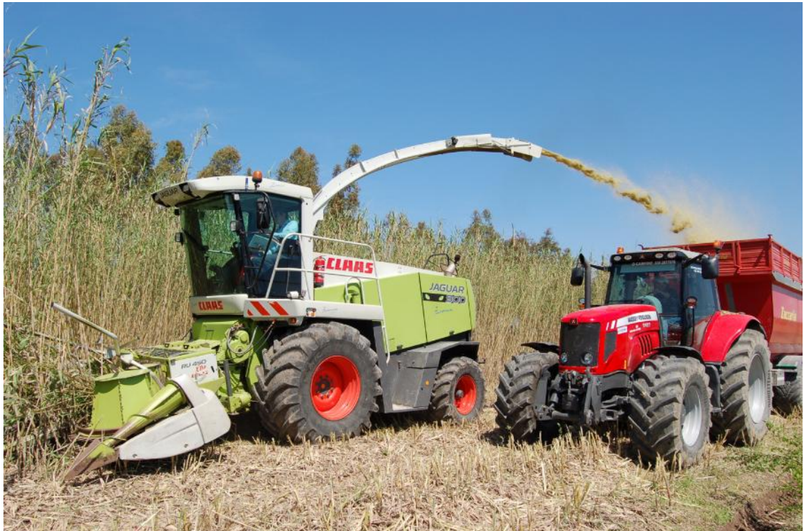
Figura 46: Fase di raccolta della canna comune con falcia trincia caricatrice CLASS Jaguar 800 e testata RU450 Xtra.
