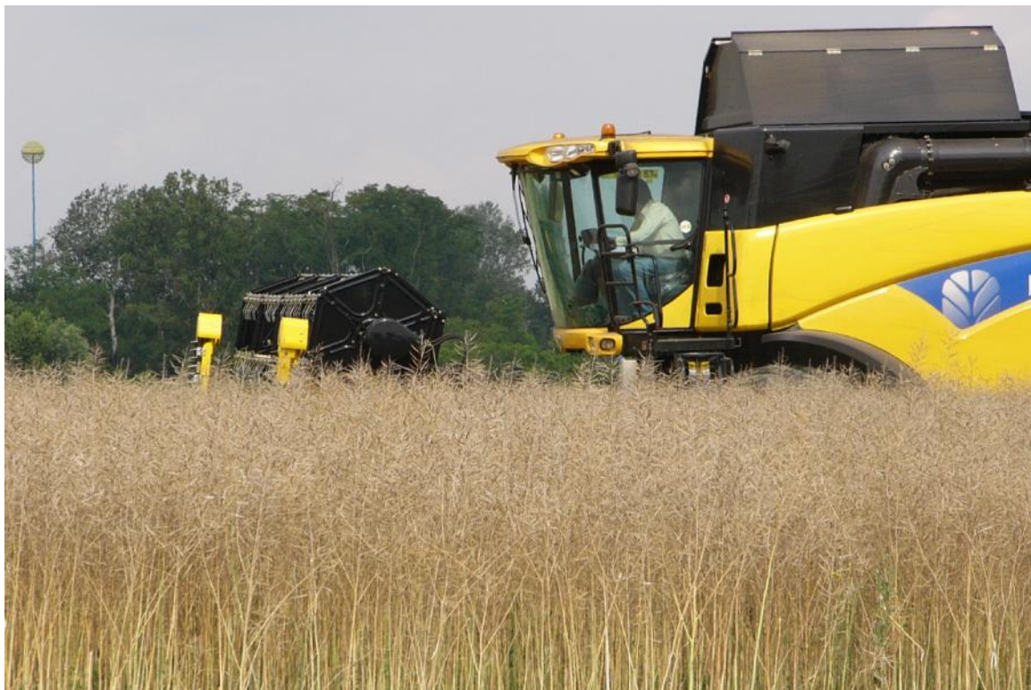
Figura 48: fase di raccolta della colza con mietitrebbia New Holland CX 8090
