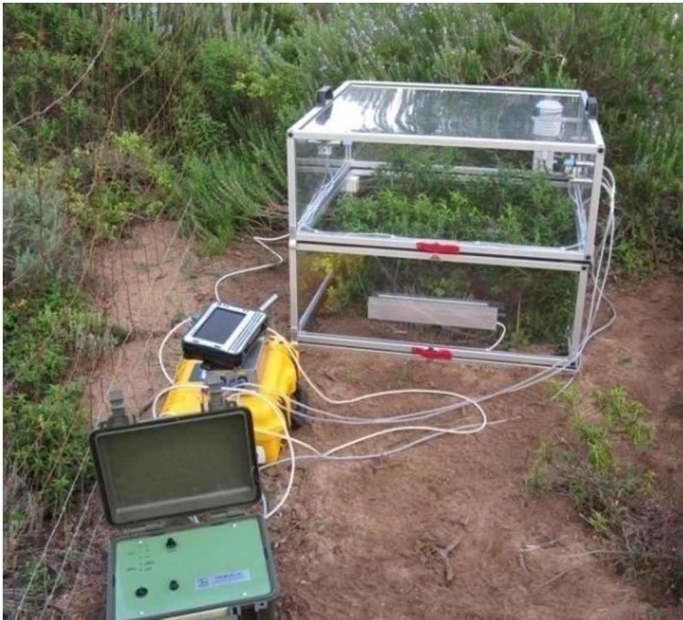
Immagine della camera per la misura degli scambi gassosi sviluppata in questo studio
