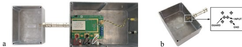
Figura 4-20 a, b: Metodo di misura dell'integrazione capacitiva - scatola di prova e connettore triax
