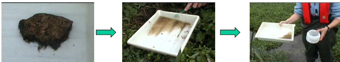
Fig. 1- Sequenza delle operazioni in caso di campionamento di ciottoli.
