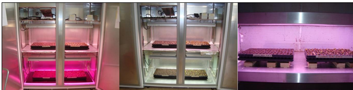
Figura 2.8 Camere di crescita con, a partire da in alto a sinistra, lampade AP67, G2; AP67-ARCH e NS2. L'ultima foto mostra la camera di crescita utilizzata con le tradizionali lampade fluorescenti.
