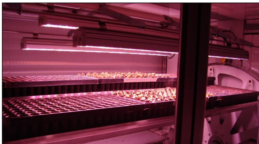
Figura 2.9 Particolare delle tre lampade LED AP67 utilizzate nel Prototipo. Nella foto è possibile notare la possibilità di riporre per ogni ripiano tre contenitori alveolari QPD144 QuickPot.
