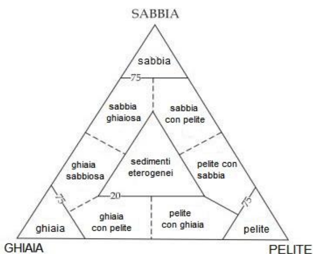
Fig. 32 - Diagramma ternario rappresentante la composizione granulometrica percentuale di sabbia, ghiaia e pelite.
