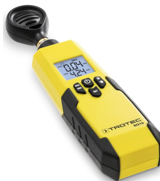
Figura 1.6: BQ16 - Misuratore di HCHO/TVOC (Trotec). Campo di misura HCHO: 0.00 - 5.00 \text{ mg/m}^3 . Campo di misura TVOC: 0.00 - 9.99 \text{ mg/m}^3 . Risoluzione HCHO: \pm 0.01 \text{ mg/m}^3 . Risoluzione TVOC: \pm 0.01 \text{ mg/m}^3 . Precisione HCHO: \pm 5\% del valore misurato. Precisione TVOC: \pm 10\% del valore misurato.
