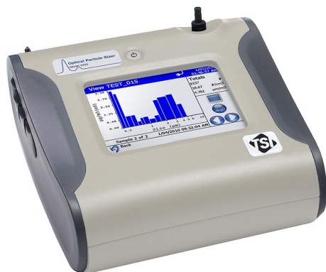
Figura 1.4: OPS 3330, TSI (Minnesota, USA). Concentrazione massima: 3000 \text{ part/cm}^3 e tra 0.001 e 275000 \mu\text{g/m}^3 . Range dimensionale: 0.3 - 10 \mu\text{m} . Frequenza di campionamento \geq 1 \text{ s} . Portata volumetrica: 1 \text{ L/min} per l'aerosol campione e 1 \text{ L/min} per il flusso di supporto.
