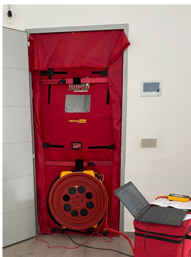
(a) Interno appartamento - Fase pressurizzazione.
