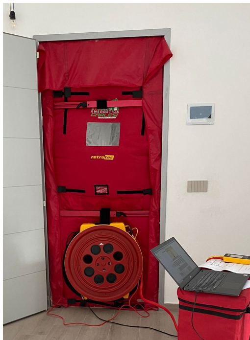
Figura 2.2: Unità abitativa sottoposto a Blower-Door-Test.
