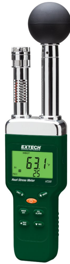
Figura 1.2: Globotermometro Extech HT200 (GEASS). Strumentazione per il campionamento di: temperatura di globo umido WBGT ( 0-59^{\circ}\text{C} \pm 1^{\circ}\text{C} ), temperatura dell'aria ( 0-50^{\circ}\text{C} \pm 0,5^{\circ}\text{C} ), temperatura di globo nero ( 0-80^{\circ}\text{C} \pm 0,5^{\circ}\text{C} ) e umidità relativa ( 1-99\% \pm 2\% ).
