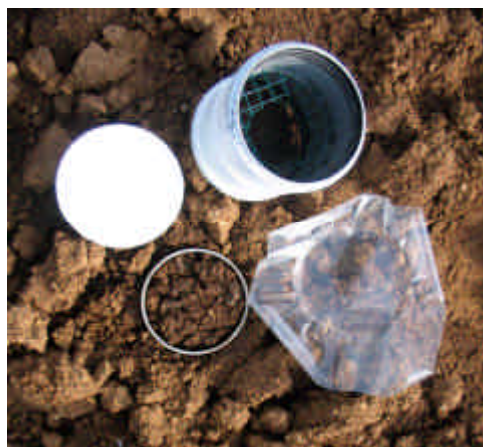
Fig. 20. Elementi costituenti le camere utilizzate per la misura del flusso di CO 2 dal suolo. In alto a sinistra: tappo di chiusura; in alto a destra: il cilindro con guarnizioni e rete di sospensione per la trappola; in basso a destra: membrana impermeabile alla CO 2 ; in basso a sinistra: collare infisso nel terreno per l'innesto della camera.
