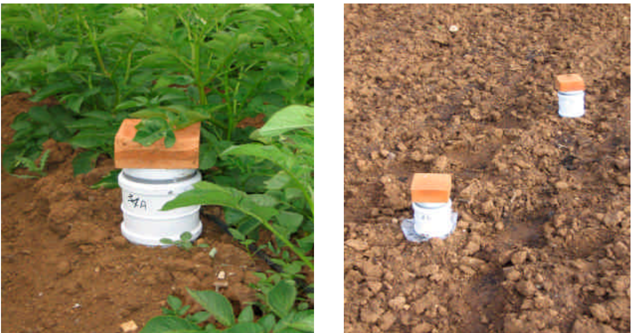
Fig. 21- Sinistra: particolare di camera con trappola ad alcali posizionata in campo lungo la fila (14/06/05). Destra: particolare delle due camere posizionate su terreno lavorato, con membrana impermeabile alla CO 2 (primo piano) e senza membrana (18/03/06).
