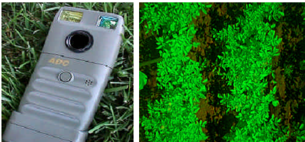
Fig. 13-. La macchina fotografica digitale Dycam ADC ed un esempio di immagine in falso colore acquisita patate (rosso = rosso, verde = vicino infrarosso).
