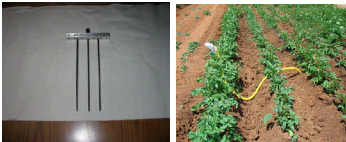
Fig. 16. A Sx particolare della sonda TDR, a Dx la sonda posizionata in campo lungo la terza fila interna alla parcella
