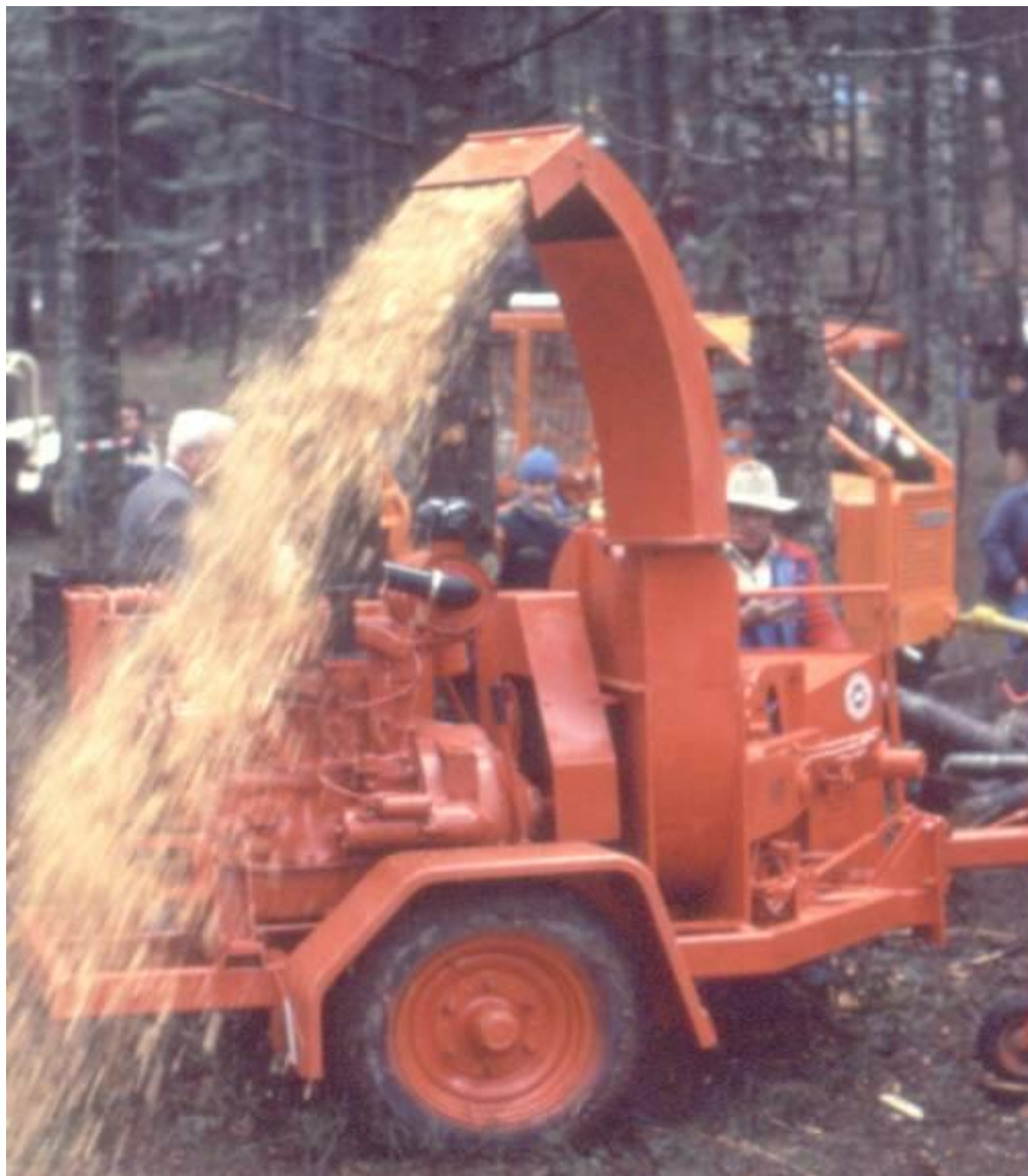
Figura 7: Sminuzzatrice a disco con alimentazione manuale
