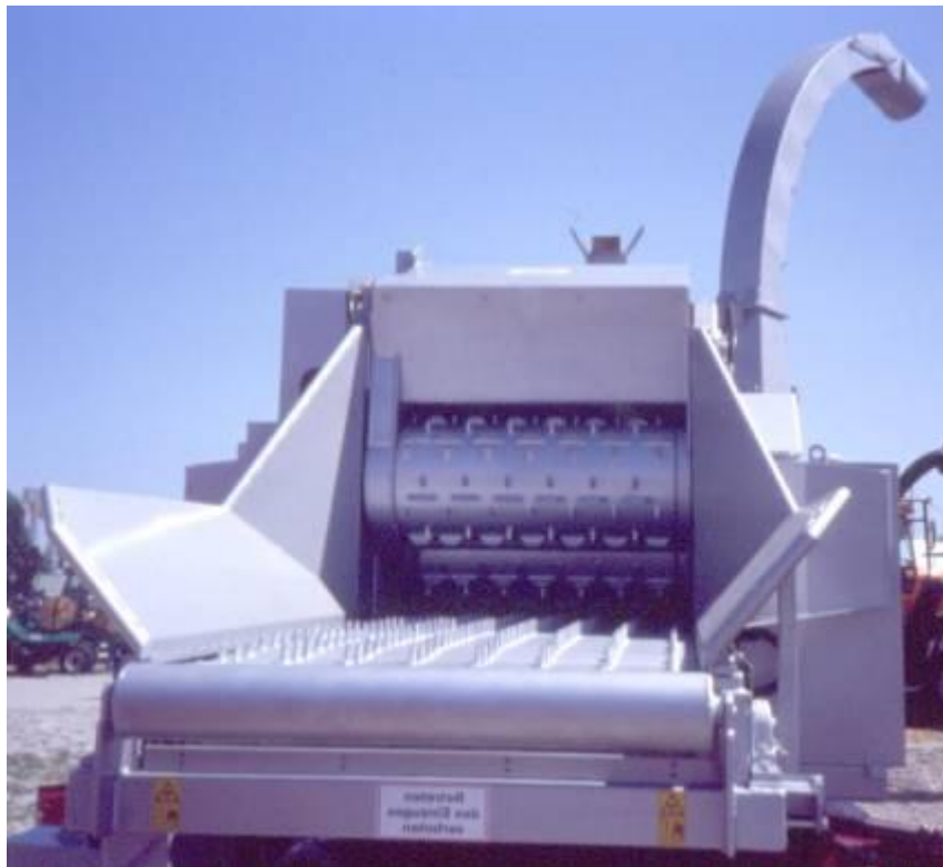
Figura 8: Sminuzzatrice a tamburo con alimentazione manuale e motore autonomo
