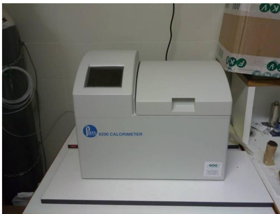
Figura 13: bomba calorimetrica adiabatica Parr 6200.
