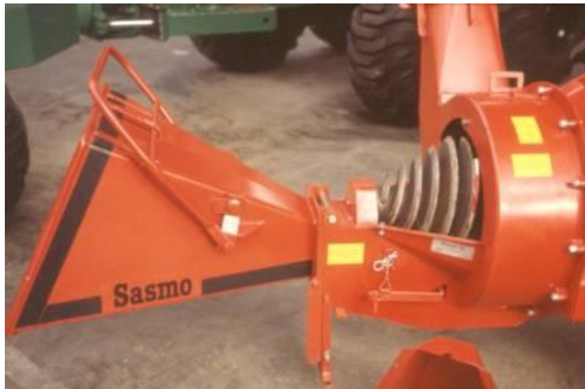
Figura 9: Sminuzzatrice a vite senza fine con alimentazione manuale
