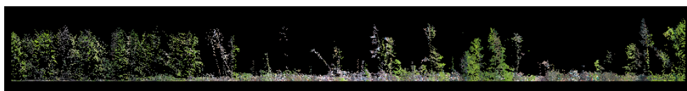
Figura 4 - Esempio di cross-profile della nuvola di punti LiDAR del volo GeoCart in una delle zone danneggiate. Si individuano chiaramente le aree con alberi ancora in piedi e quelle con alberi a terra.
