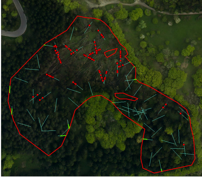
Figura 8 - Esempio di individuazione dell'area di danno effettivo con eliminazione delle isole non danneggiate.
