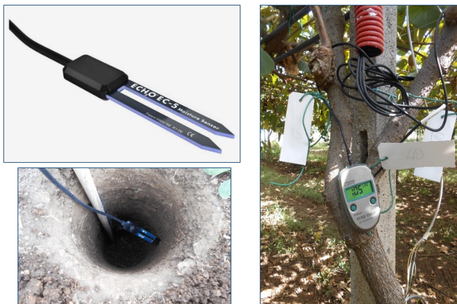
Figura 26. Sensore (ECHO EC-5) per la determinazione volumetrica del contenuto dell'acqua nel terreno basato sulla tecnologia Frequency Domain Reflectometry (FDR) e lettore digitale dei dati (METER Group)
