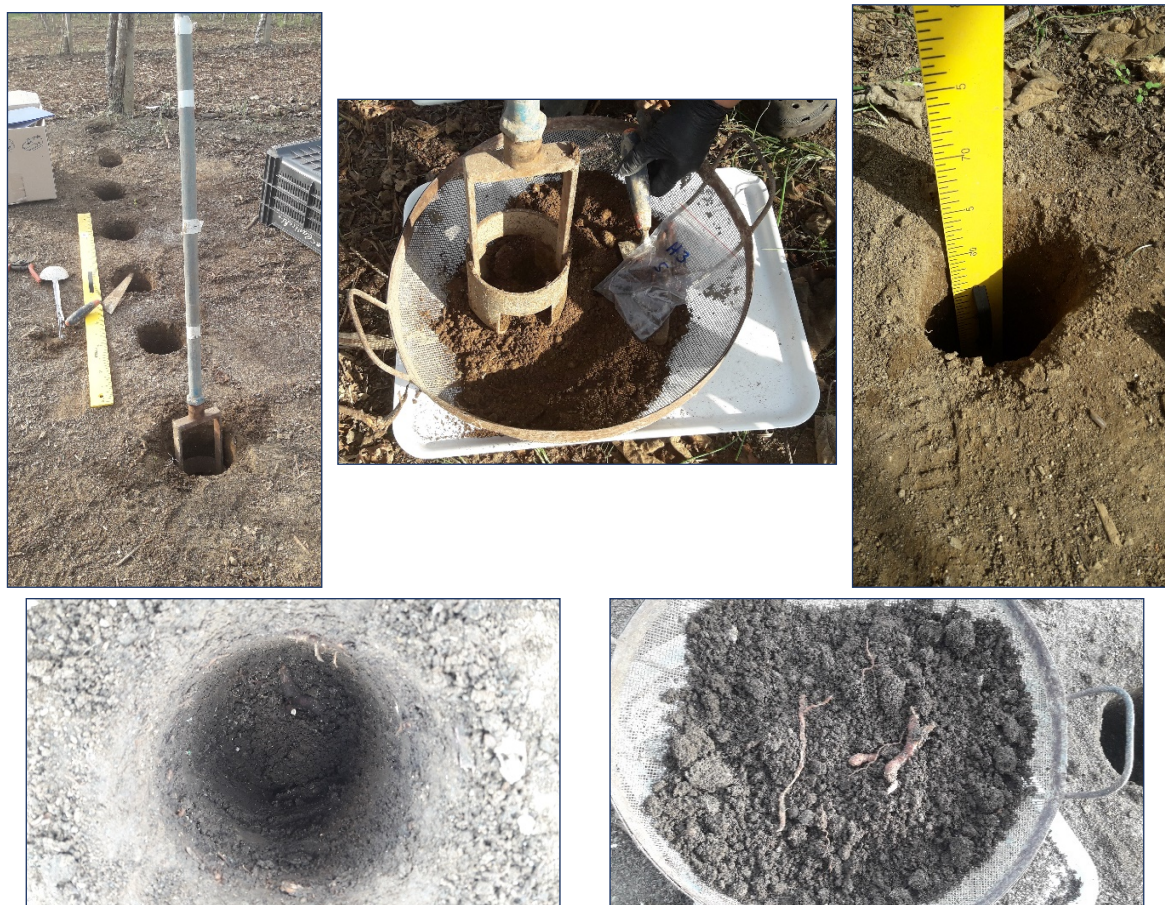
Figura 30. Carotaggio a diverse distanze dalla fila e a diverse profondità per studiare lo sviluppo del sistema radicale nel terreno
