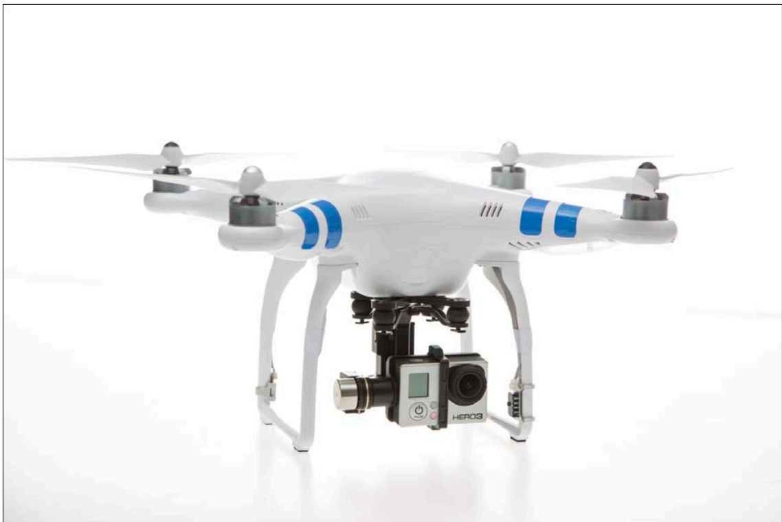
Figura 2.6 immagine del quadricottero Phantom 2 della DJI utilizzato per le prove di acquisizione fotogrammetrica
