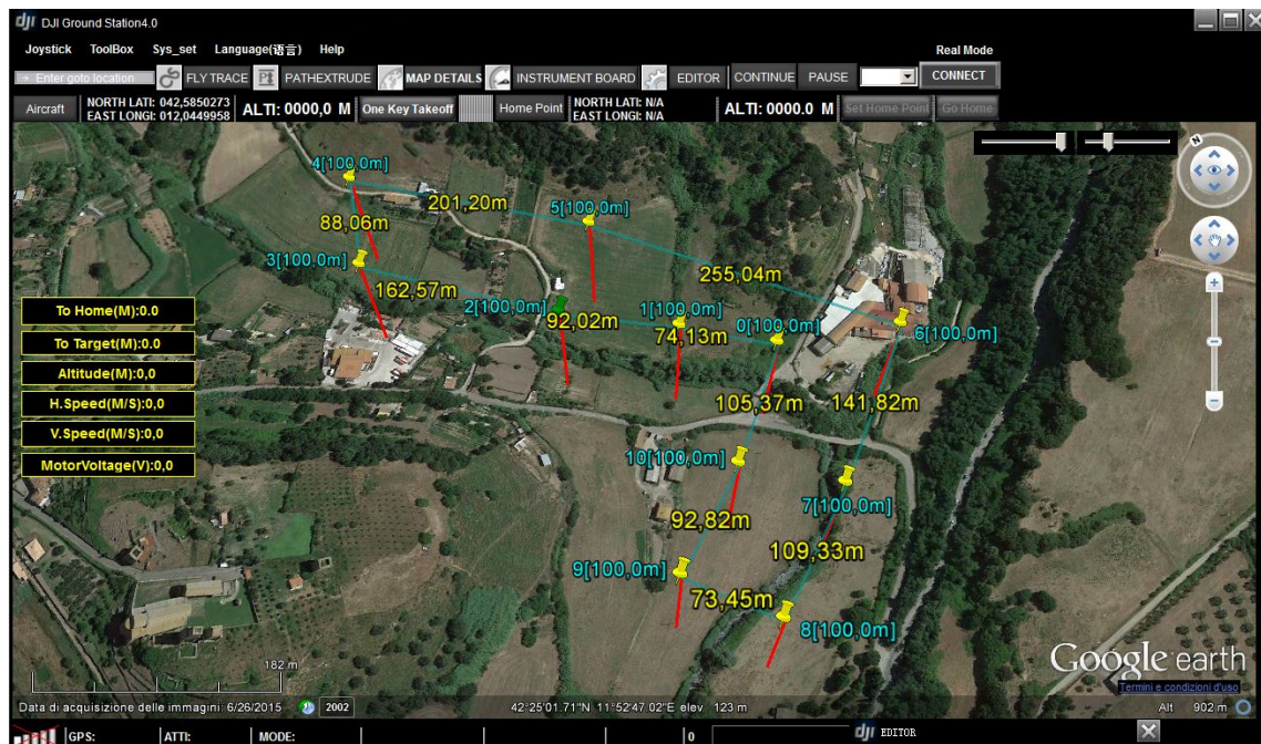
Figura 2.11 illustrazione della missione programmata, nell'immagine sono indicati i waypoint utilizzati per l'acquisizione
