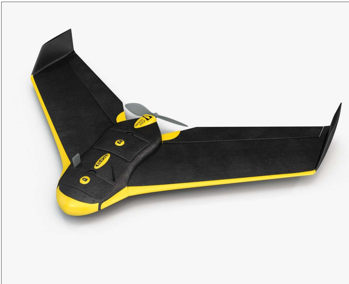
Figura 2.5 il modello SenseFly eBee è uno dei modelli più diffusi utilizzato per la fotogrammetria
