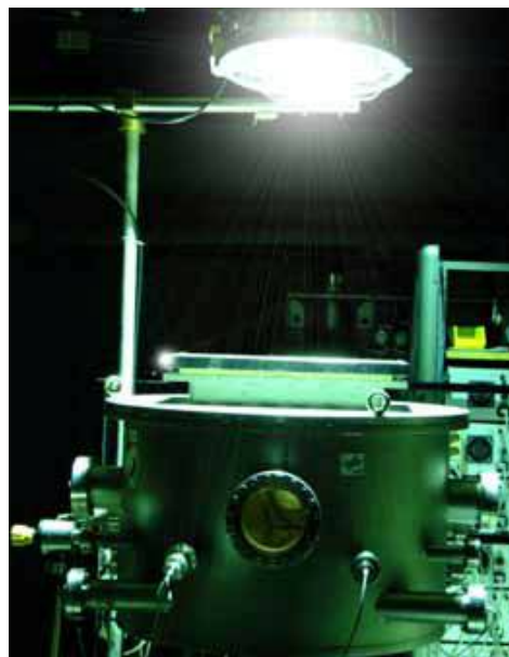
Figura 2.11 – Space simulation facility PSI 2 per le oscillazioni termiche e l'irraggiamento UV policromatico (fonte: DLR, Colonia, Germania).
