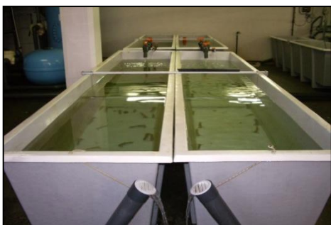
Figura 1-Alcune vasche del circuito aperto (CA).
