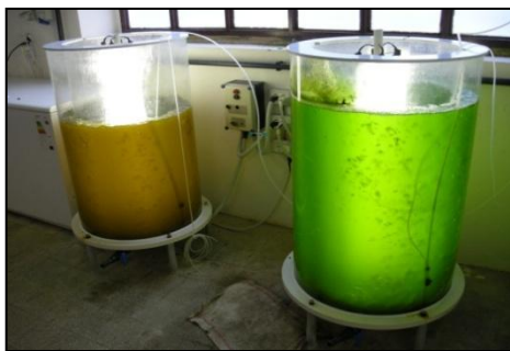
Figura 5- Bioreattori per l'allevamento di fitoplancton.
