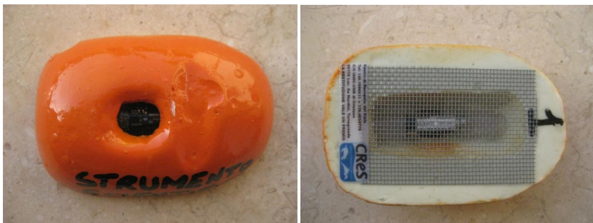
Figura 43. Pop up ultimato e visto dall'alto (sx) e visione inferiore dove si nota la retina che protegge il TDR, la targhetta con i recapiti del CReS e il numero identificativo del Pop up (dx)
