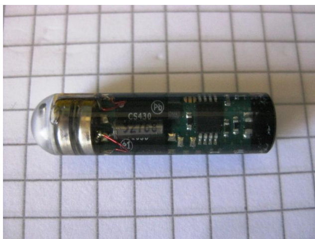
Figura 41. TDR fotografato su un foglio di quaderno a quadretti (5 mm) che ne evidenzia la ridotta dimensione
