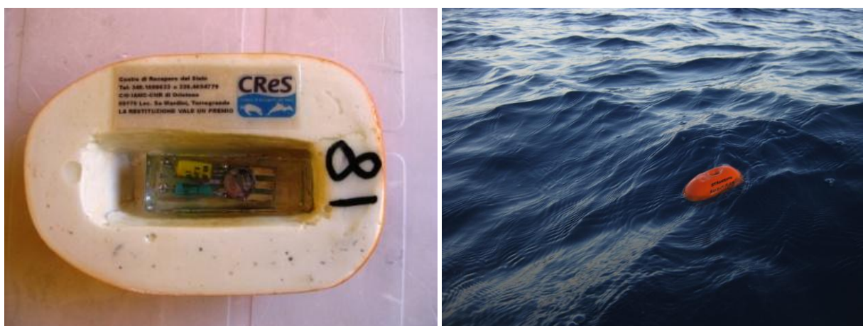
Figura 47. Pop up "fake" realizzati con un finto TDR all'interno (sx) e dispositivo rilasciato in mare aperto, in stato di galleggiamento (dx)
