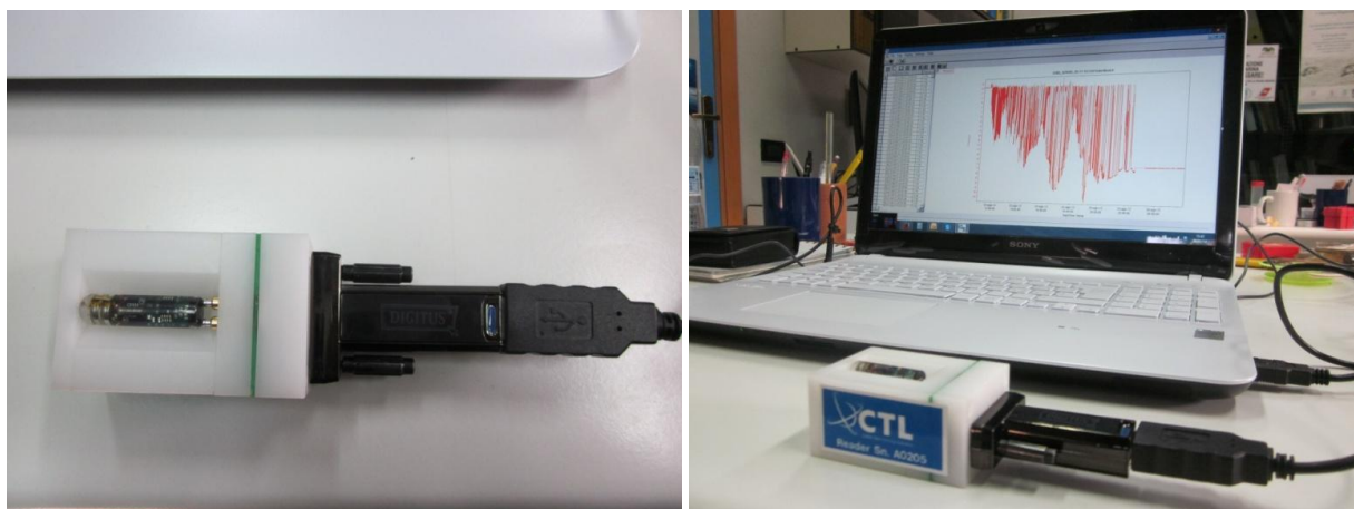
Figura 42. Lettore in cui viene alloggiato il TDR (sx) e download dei dati registrati sul PC (dx)
