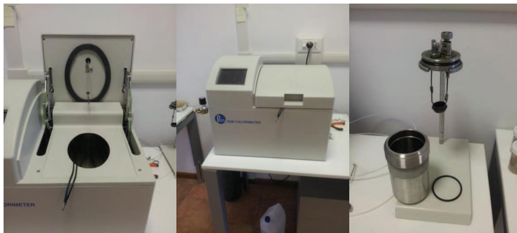
Figure 2.19 e 2.20. Calorimetro Parr 6200 per la determinazione del potere calorifico superiore.
