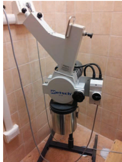
Figura 2.7. Mulino a taglienti Retsch SM100 per la fase di preparazione del campione (Manuale Utente Retsch SM100).
