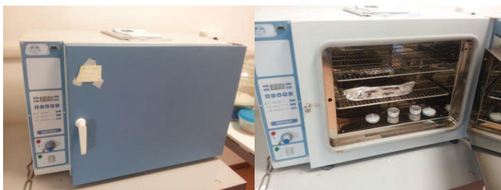
Figura 2.3. e 2.4. Stufa a convezione naturale per essiccazione Digitheat, in grado di mantenere la temperatura costante a (105\pm 2) °C, utilizzabile per la determinazione del contenuto totale di umidità e del contenuto di umidità del campione generale d'analisi.
