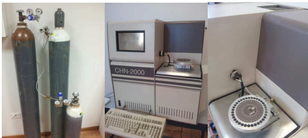
Figura 2.13. Bombole di ossigeno ed elio necessarie per il funzionamento del macchinario CHN 2000.
