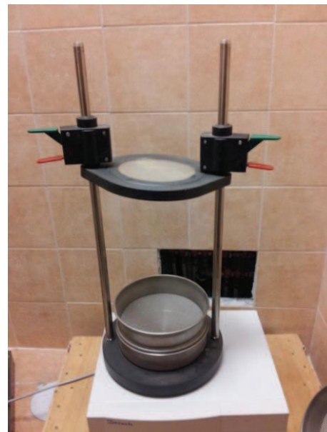
Figura 2.9. Setacciatore Retsch AS 200 Control per la fase di preparazione del campione (Manuale Utente Retsch AS 200 Control)
