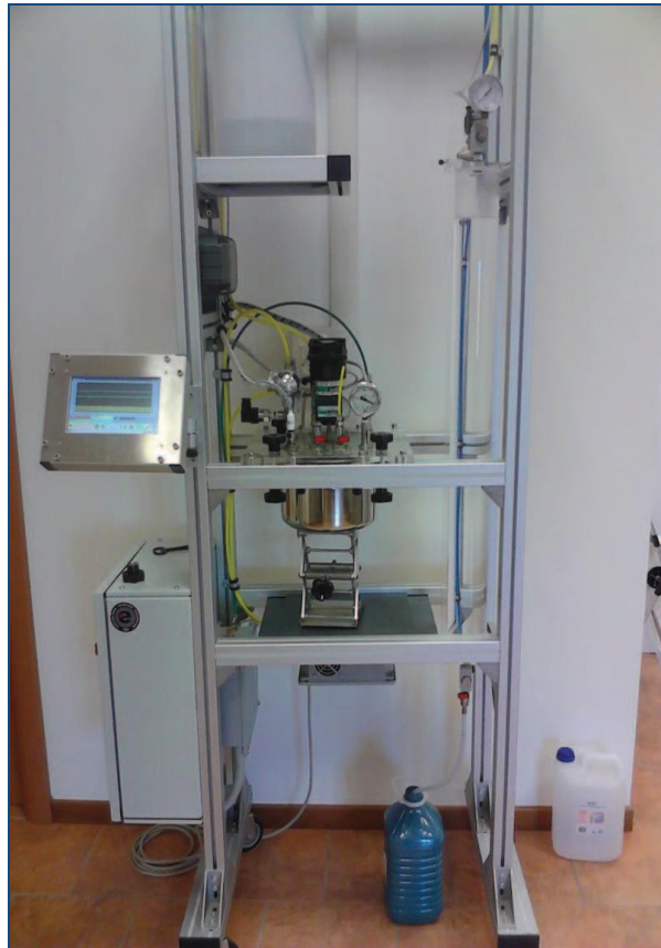
Figura 4.3. Mini-impianto di digestione anaerobica
