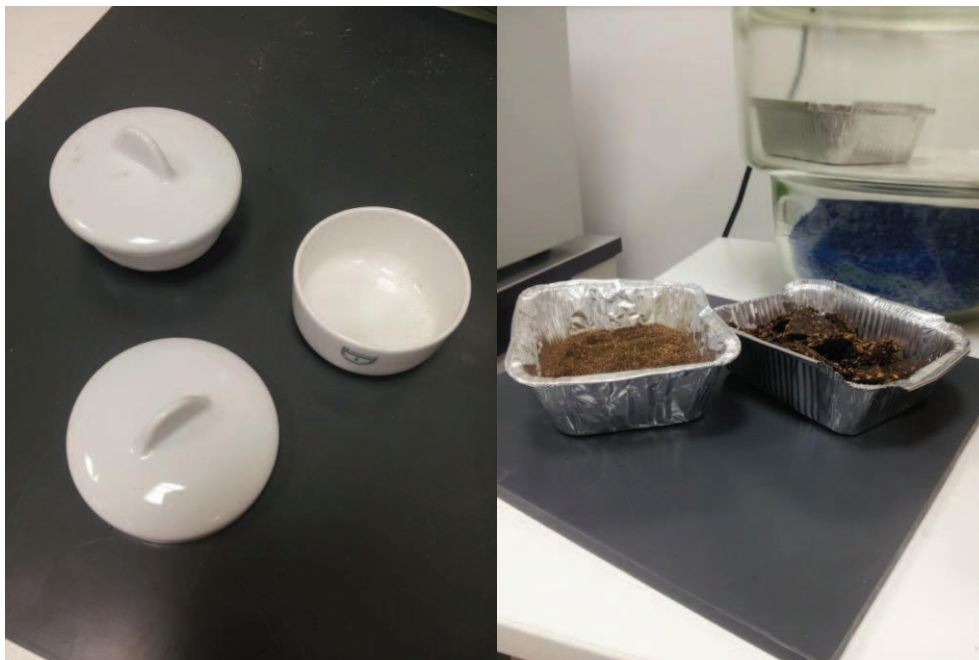
Figura 2.5. Crocioli di ceramica per la determinazione dell'umidità del campione generale di analisi e delle ceneri.
