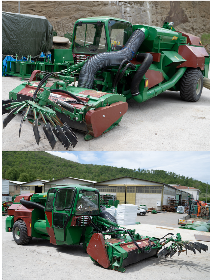
Figura 1.1: Raccoglitrice semovente FACMA Cimina 300S, munita di raccoglitore meccanico RM170 e cabina di guida.
