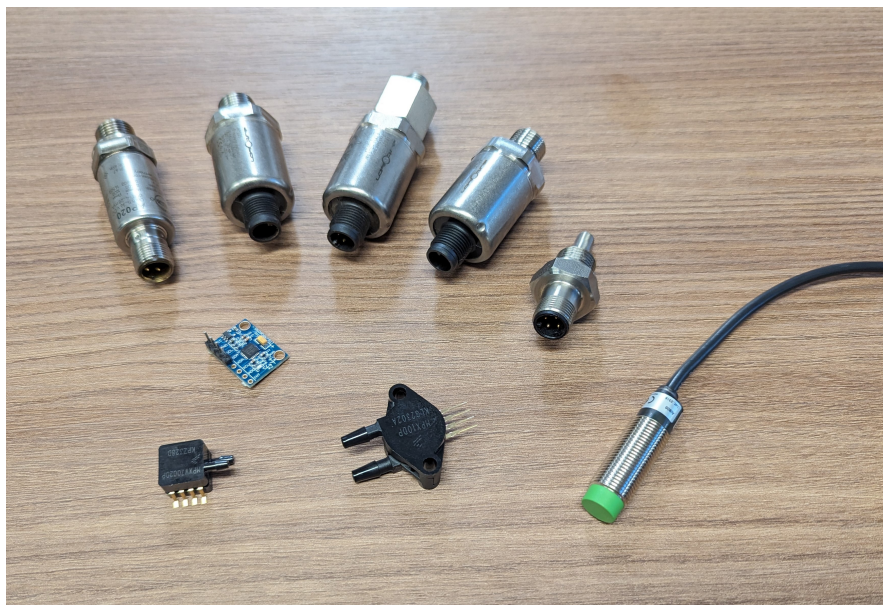
Figura 2.17: Alcuni sensori impiegati nel sistema di acquisizione: trasmettitori di pressione, sensori di pressione differenziale, pt100, sensore Hall e accelerometro.
