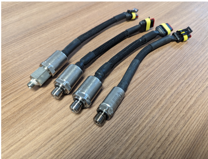
Figura 2.20: Trasmettitori di pressione dell'olio muniti di cavi e connettori, pronti per l'installazione sulla semovente.
