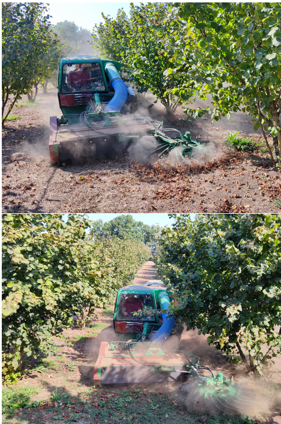
Figura 3.1: Semovente Cimina 300S in funzione durante il primo giorno di raccolta.
