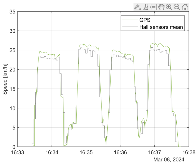
Figura 3.10: Velocità del veicolo media misurata con i sensori Hall e GPS a confronto durante il test della massima velocità su strada.
