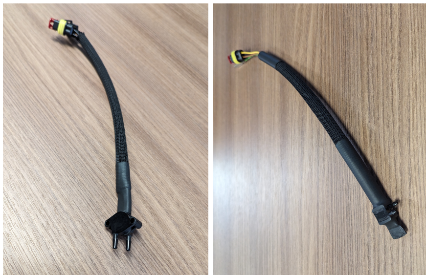
Figura 2.18: Sensori di pressione differenziale dell'aria muniti di cavi e connettori, pronti per l'installazione sulla semovente.
