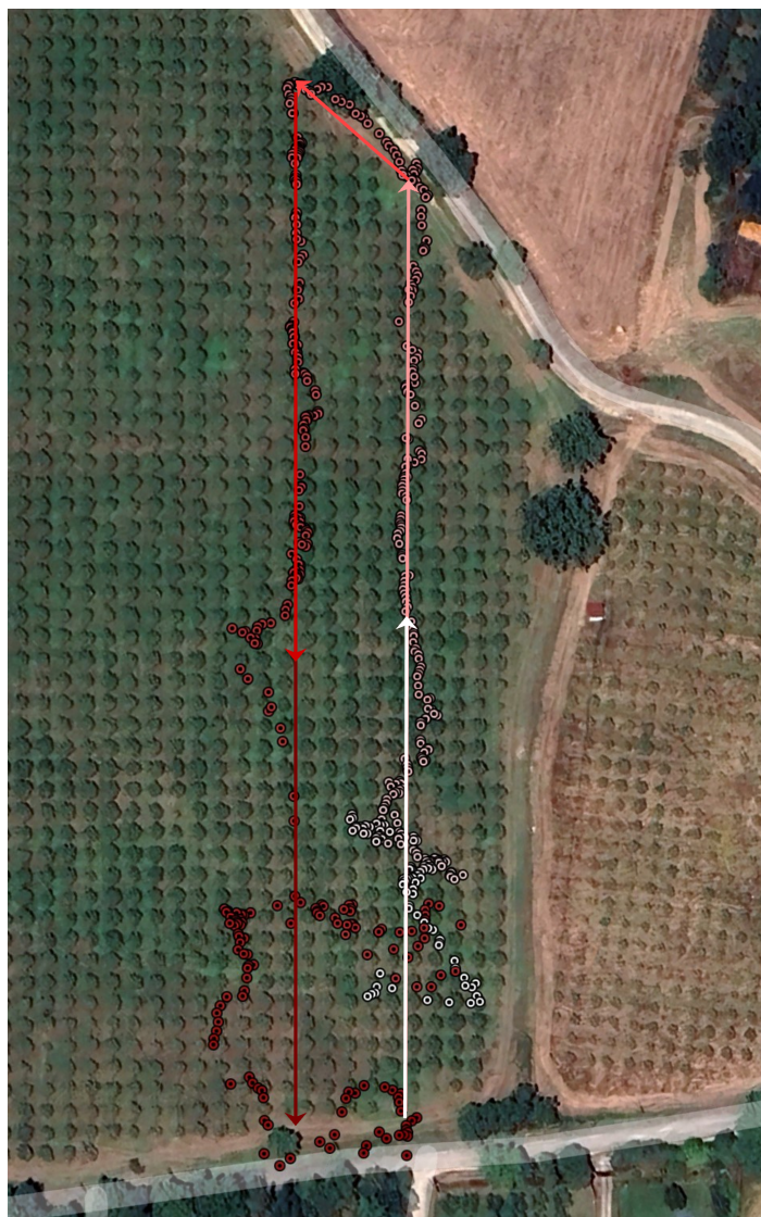
Figura 3.25: Posizioni registrate della macchina, nel primo giorno di raccolta, dalle 10:12 alle 10:24, comparate al tragitto realmente percorso.
