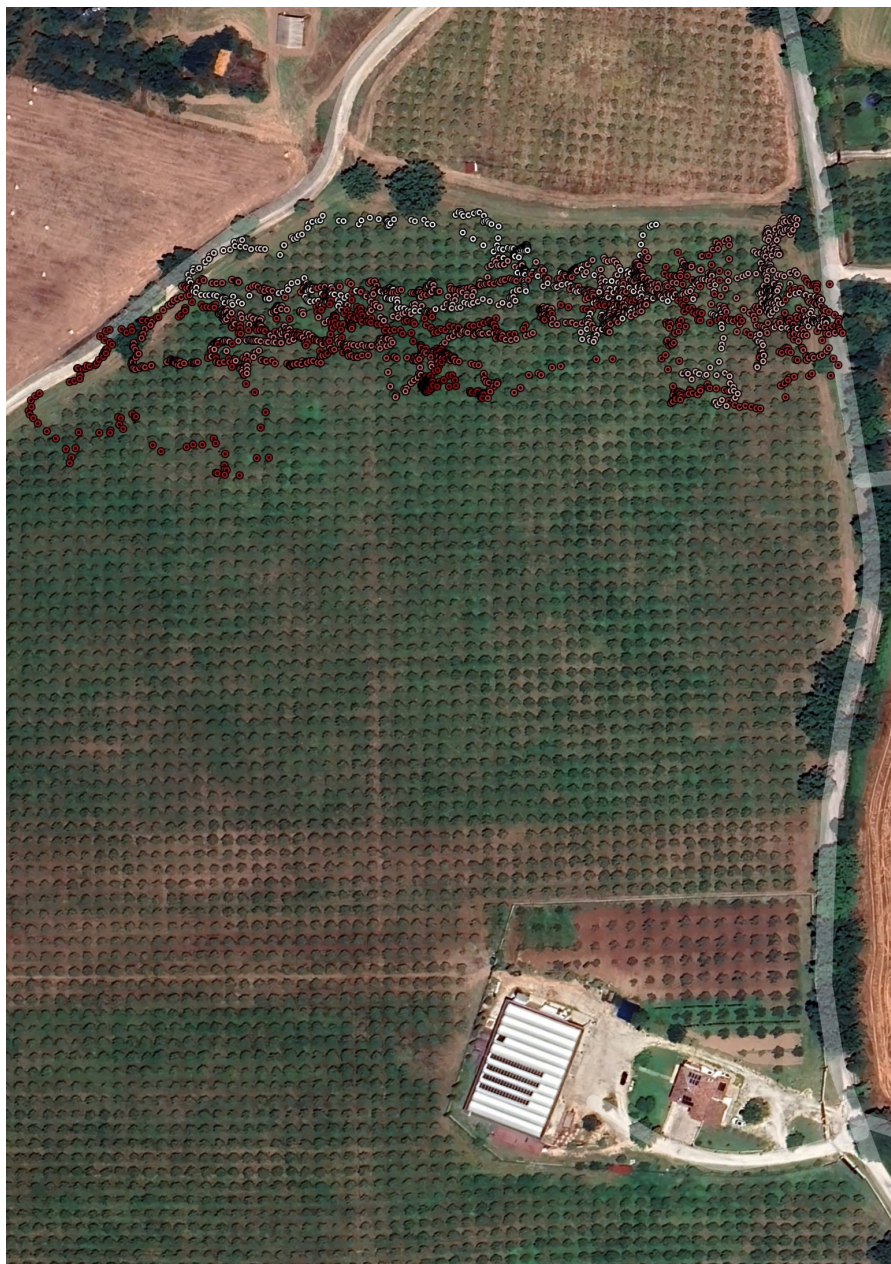
Figura 3.24: Posizioni registrate della macchina, nel primo giorno di raccolta, dalle 9:40 alle 10:40, colorate in funzione del tempo di acquisizione.
