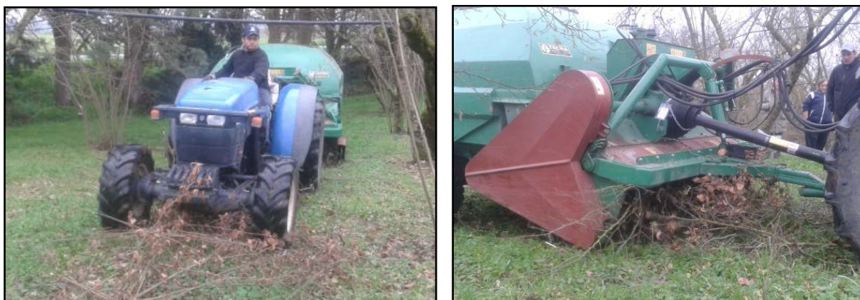
Figura 28. Raccolta delle potature con macchina trinciatrice Farma, modello Comby 200;
