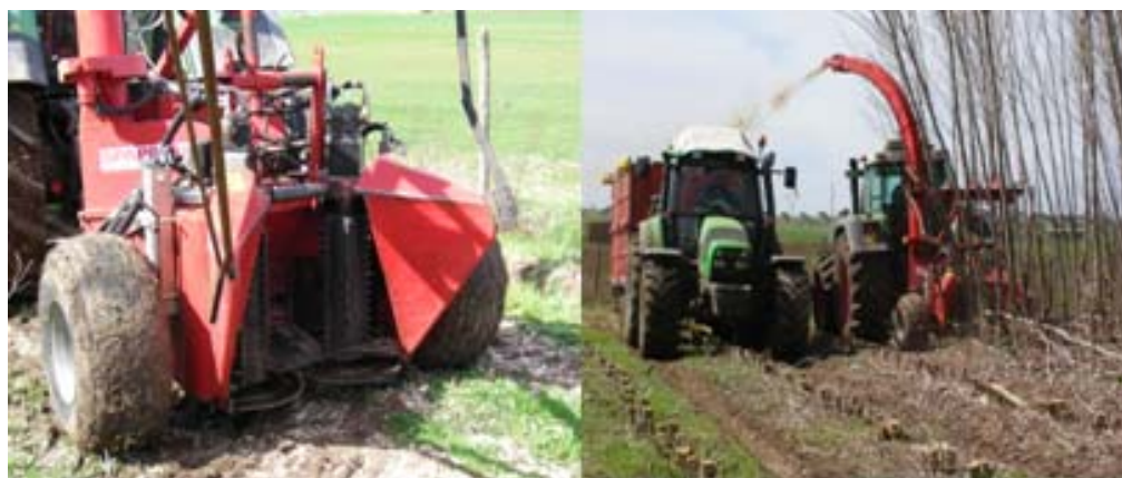
Foto 3.6: Macchina raccoglitrice con testata semiportata Spapperi per impianti con turni maggiori o uguali a due anni
