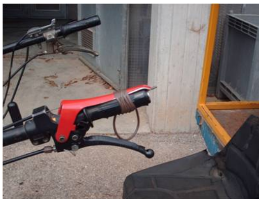
foto 1 rimozione degli elementi di protezione
