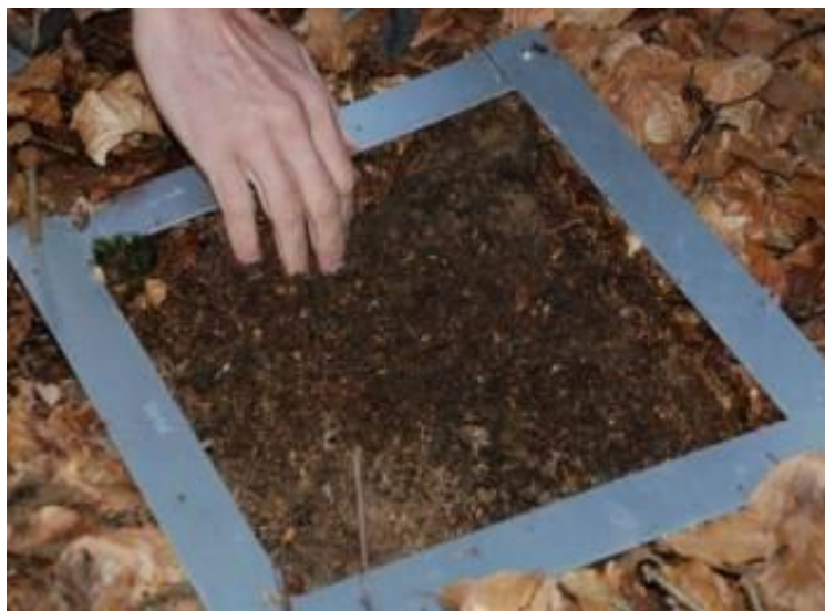
Figura 5 – cornice metallica da 20x20 cm per la delimitazione dell'area di prelievo della lettiera.
