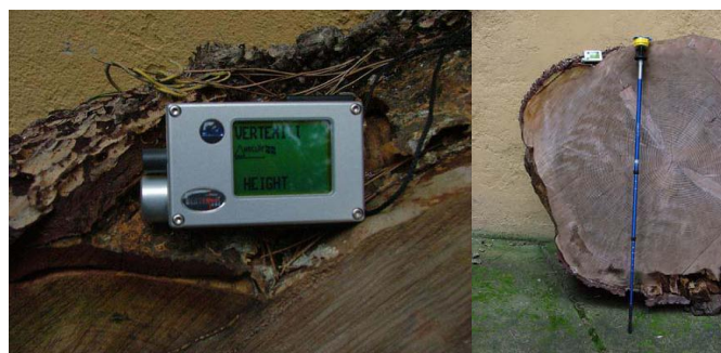
Figura 34 Apparato trasmettitore e "transponder" del Vertex III.
