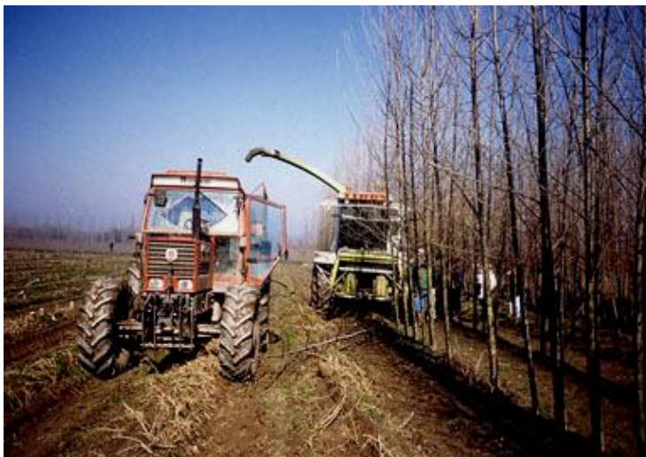
Figura 30 Impianto di Short Rotations Forestry realizzato per la sola produzione di biomassa energetica, in cui un razionale concepimento favorisce l'impiego di macchinari per le operazioni di raccolta (Fonte: www.cfav.altavaltellina.org )
