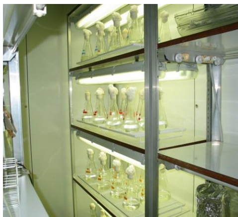
Figura 7. Camera termostatica per colture algali.
