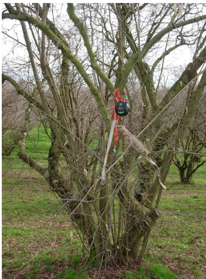
Foto 3.1: pesatura della fascina di potatura attraverso l'utilizzo del dinamometro digitale.
