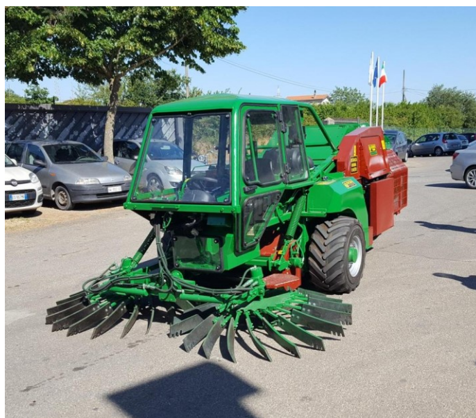
Fig. 3.1: Raccoglitrice di nocciole semovente
