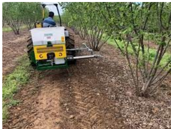
Fig. 5: Esempio di spandimento localizzato di pellettato da reflui zootecnici
