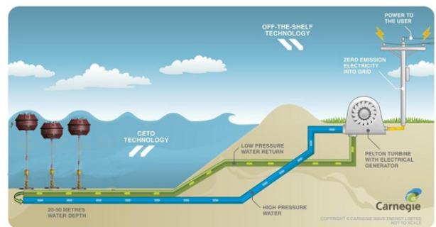
Figura 5-2. A sinistra dispositivo Aquamarine Power. A destra descrizione sintetica del sistema CETO, Carnegie Wave Energy
