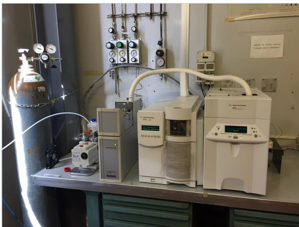
Figura 35 Gas-cromatografo collegato al desorbitore termico, necessario per la preparazione dei campioni.
