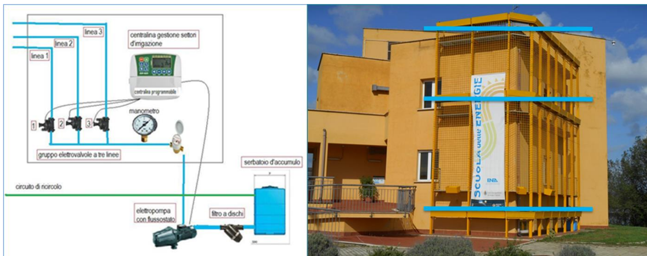
Figura 19 Schema dell'impianto irriguo della facciata verde, in blu nell'immagine di destra è riportata la collocazione delle linee di irrigazione presenti sulla struttura.
