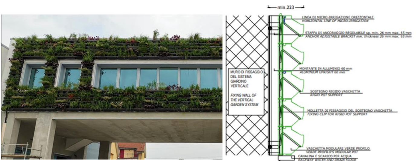
Figura 3 Muro verde continuo realizzato su palazzo Beltrame, Milano, dallo studio Sandrini Architecture, foto (www.sandrini.it). Sulla destra schema costruttivo di muro verde continuo ( https://verdeprofilo.com ).
