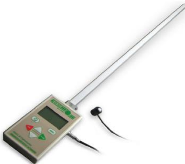
Figura 29 Ceptometro ACCUPAR LP-80, lo strumento ha 80 sensori della PAR collocati lungo la barra più un sensore di controllo esterno, possiede un campo di misura da 0 a 2,500 \mu\text{mol m}^{-2} \text{s}^{-1} ed una risoluzione di 1 \mu\text{mol m}^{-2} \text{s}^{-1}
