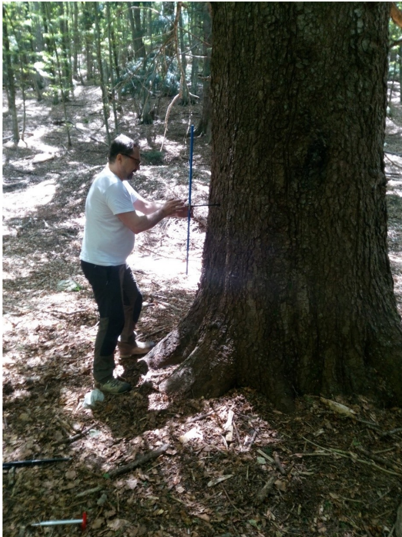
Figura 3.10 – particolare di uno degli esemplari di abete bianco oggetto di prelievo di carote incrementali mediante succhiello di Pressler
