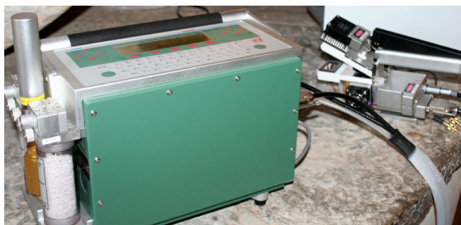
Fig. 16 – Analizzatore di gas ad infrarossi per la determinazione degli scambi gassosi delle foglie
