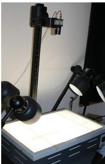
Fig. 13 – Sistema WinDias per il calcolo dell'area fogliare delle piante
