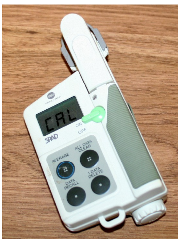
Fig. 15 – Misuratore SPAD per il calcolo del contenuto in clorofilla delle foglie
