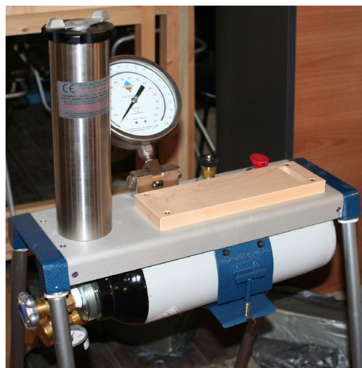
Fig. 14 – Camera di Scholander per la determinazione del potenziale idrico delle piante
