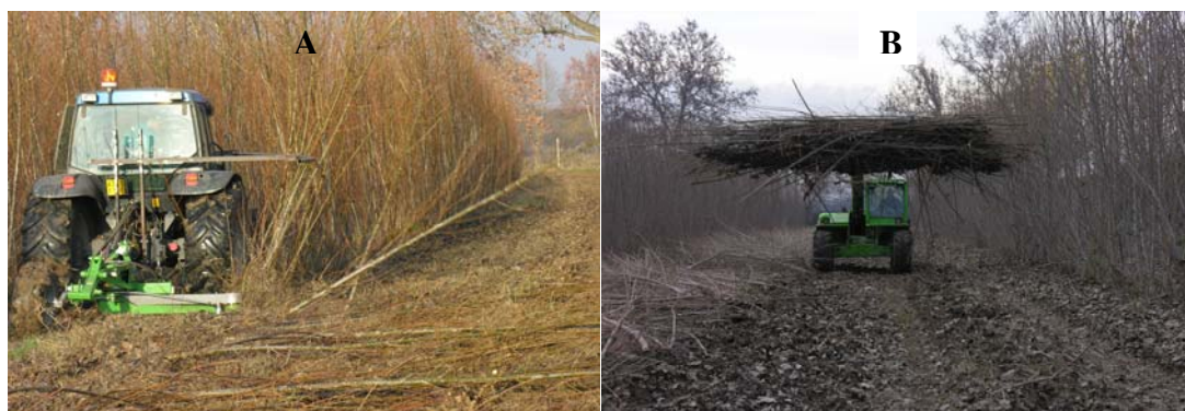
Figura 37. Raccolta della SRF con Taglia ceppaie (A) che esegue l'abbattimento delle piante intere le quali vengono trasportate fuori campo e accatastate da un trattore munito di pinza anteriore (B).
