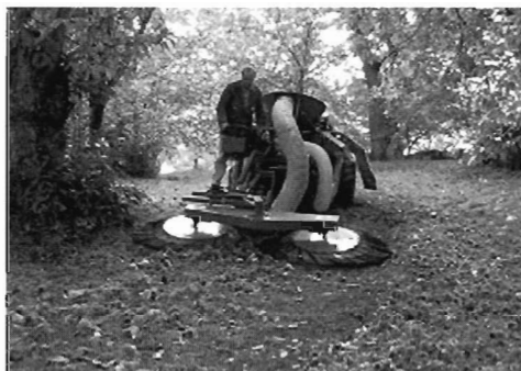
Fig. 2 - Aspiratrice semovente FACMA.
